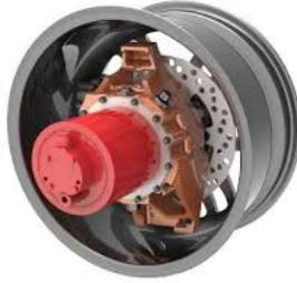
Figura 1.3: Motoruota. In rosso il motore elettrico.
