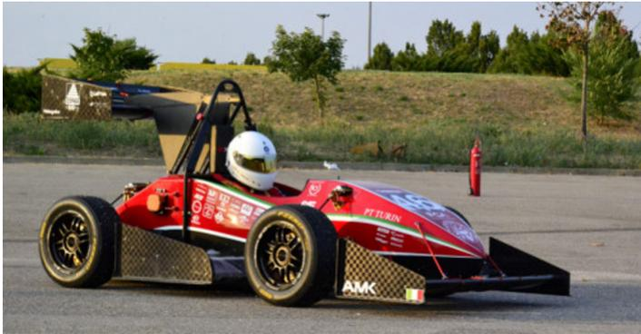
Figura 1.1: Monoposto a trazione elettrica integrale della Squadra Corse.
