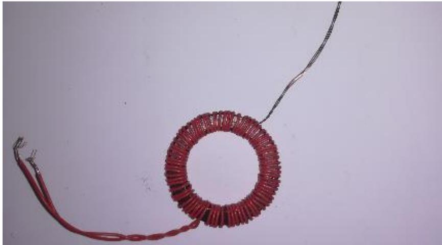
*Figura 5-8: Toroide avvolto per caratterizzazione magnetica*
