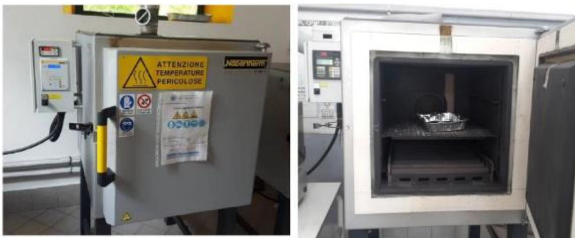
*Figura 4-7: Forno per trattamenti in ambiente ossidante*
