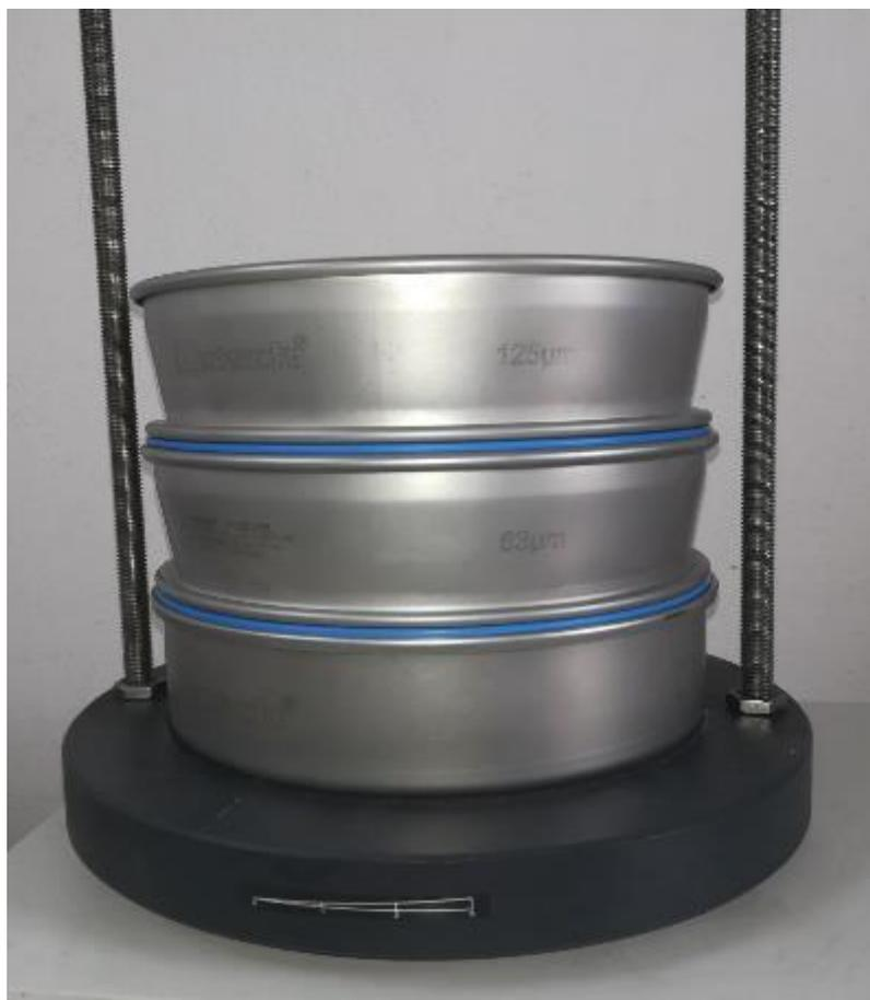
*Figura 4-1: setacci impilati per ottenere le polveri di ferro S1, S2 ed S3*
