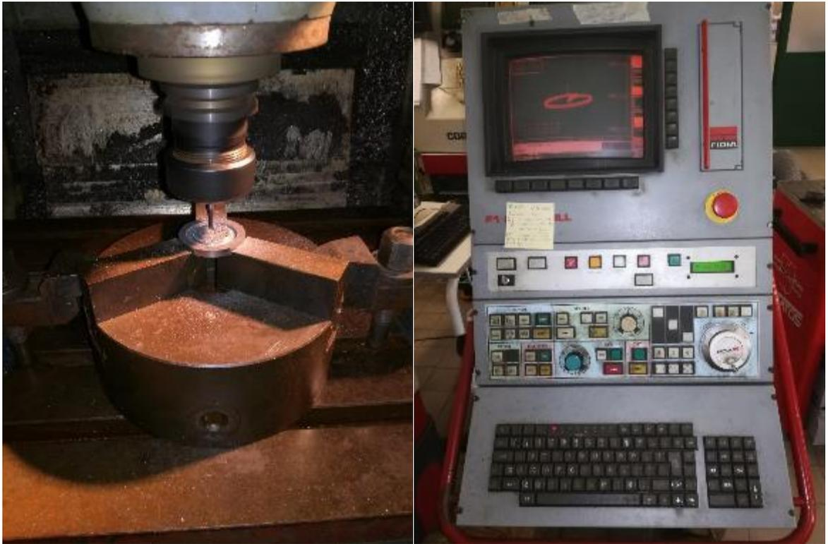
*Figura 4-6: Fresa (a sinistra) e computer a controllo numerico (destra)*
