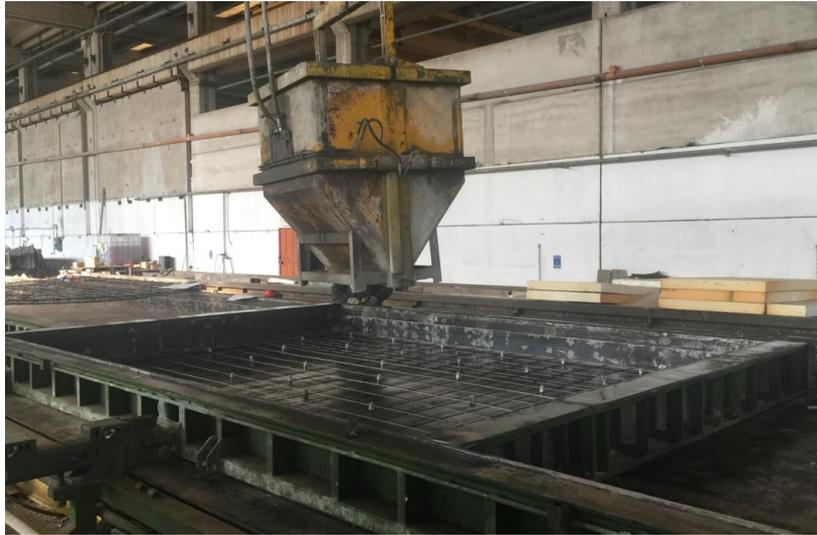
**Figura 20. 1° fase di produzione del pannello di progetto**
