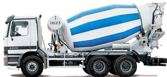
Figura 25: Autobetoniera per trasporto calcestruzzo in cantiere.
