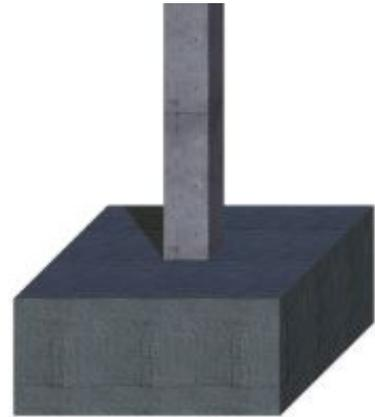
Figura 19: Elemento Plinto di fondazione gettato in opera.
