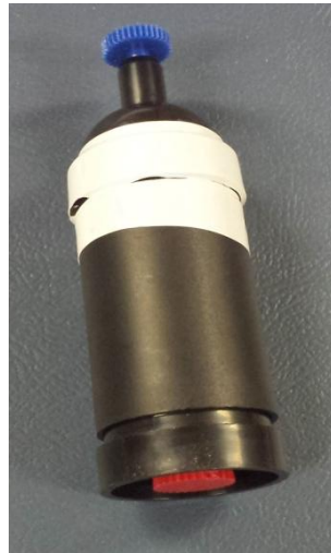
Figura 18: Portafiltro con all'interno filtro in esteri misti di cellulosa di diametro 25 mm, dimensione dei pori di 0,45 \mu\text{m} e spessore pari a 150 \mu\text{m}
