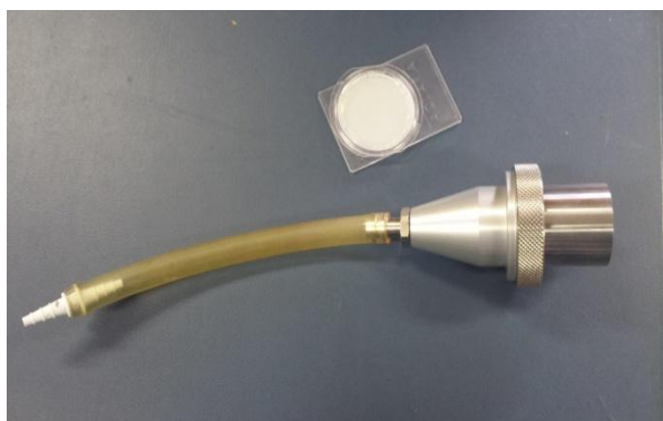
Figura 40: Elementi del campionatore. In particolare si vede la testa campionatrice in alluminio per filtri in polycarbonato con diametro di 47 mm, collegata ad un tubo aspirante flessibile prima dell'uso. In alto invece si nota un filtro "bianco" prima dell'utilizzo
