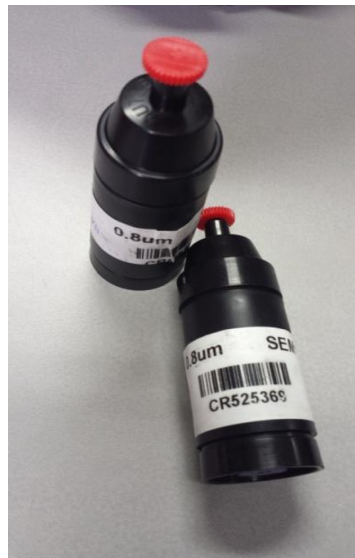
Figura 17: Portafiltri con all'interno filtri bianchi in policarbonato di diametro 25 mm e diametro effettivo di 20-22 mm, dimensione dei pori pari a 0,8 \mu\text{m} , spessore di 25 \mu\text{m}
