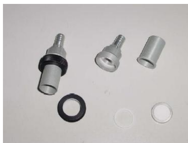
Figura 8: Portafiltro, sue componenti e filtro utilizzato per misure con MOCF 16
