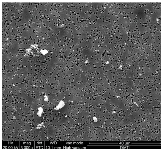
Figura 45: Risultato del campionamento con strumento personale adattato a fisso eseguito nel laboratorio “Sala Provamotori”. Analisi eseguita con SEM. Filtro in policarbonato da 25 mm di diametro. Si nota l’assenza di masse fibrose sull’intera area di indagine
