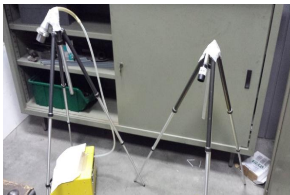
Figura 39: Posizionamento dei due campionatori ambientali con flusso di aspirazione impostato a 8 l/min, ubicati sul fondo del laboratorio e vicini ad un piano di lavoro
