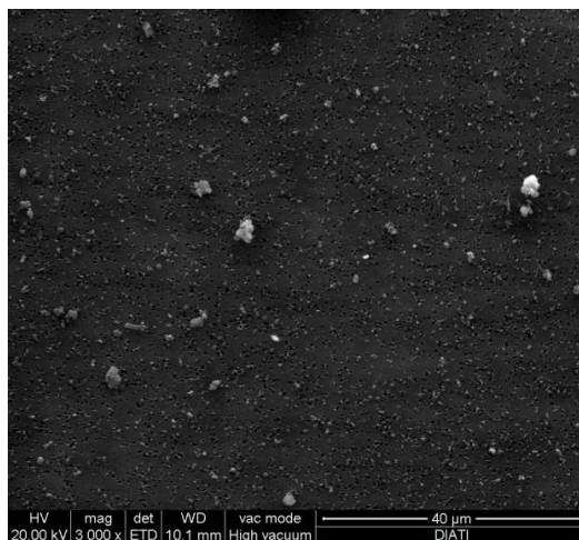
Figura 41: Risultato del campionamento ambientale eseguito nel locale “Corridoio”. Analisi eseguita con SEM. Filtro in policarbonato da 25 mm di diametro. Si nota l’assenza di masse fibrose sull’intera area di indagine
