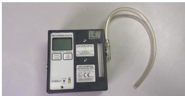
Figura 13: Visione frontale del campionatore personale (usato anche per analisi di postazione di lavoro fissa come nel caso della tesi in esame), modello UNIVERSAL DELUXE TX/XR , PCMTX4 – AMS Analitica
