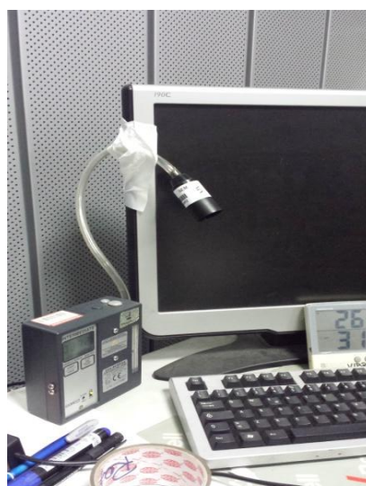
Figura 36: Posizionamento (da cono ottico 1 di Figura 34) del campionatore personale utilizzato per una postazione di lavoro fissa, con filtro in policarbonato da 25 mm di diametro e flusso di aspirazione pari a 1,8 l/min
