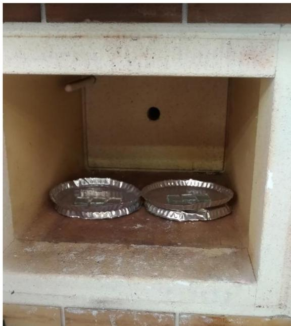
**Figura 3.4** Anodi in muffola dopo aver subito il processo di attivazione termica.
