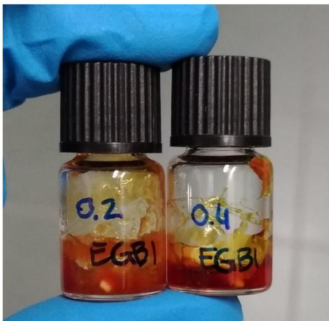
**Figura 4.10** Aspetto degli elettroliti gel additivati.
