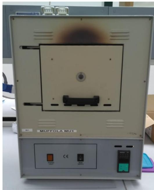
**Figura 3.2** Muffola all'interno della quale avviene il processo di sinterizzazione.
