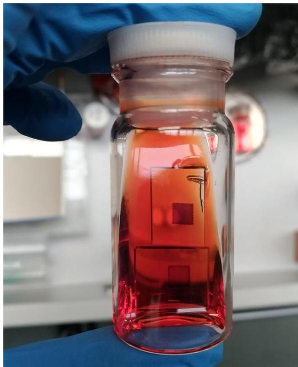
**Figura 3.7** Anodi in fase di dipping, soluzione colorante a base MK-2 per celle a base cobalto.
