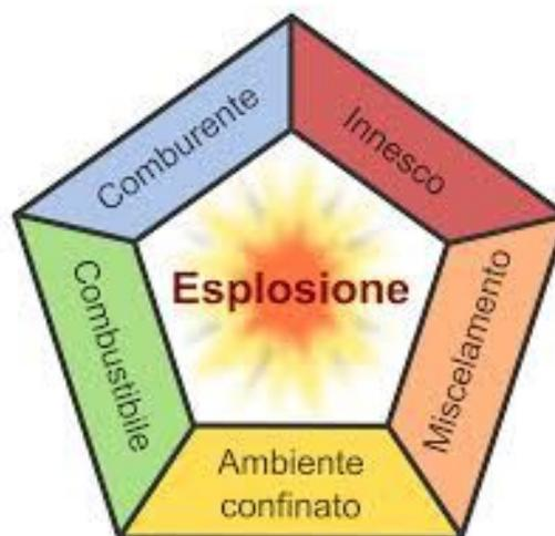
**Figura 3.3:** Pentagono dell'esplosione di polveri [9]
