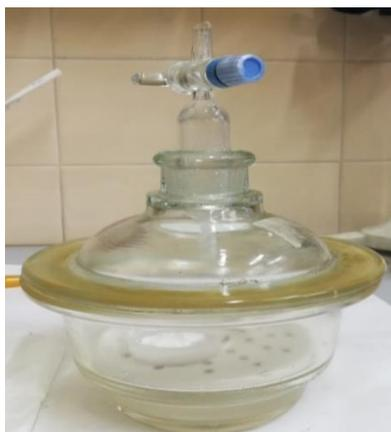
Figure 8.26 Essiccatore utilizzato per invecchiamento in ambiente umido.
