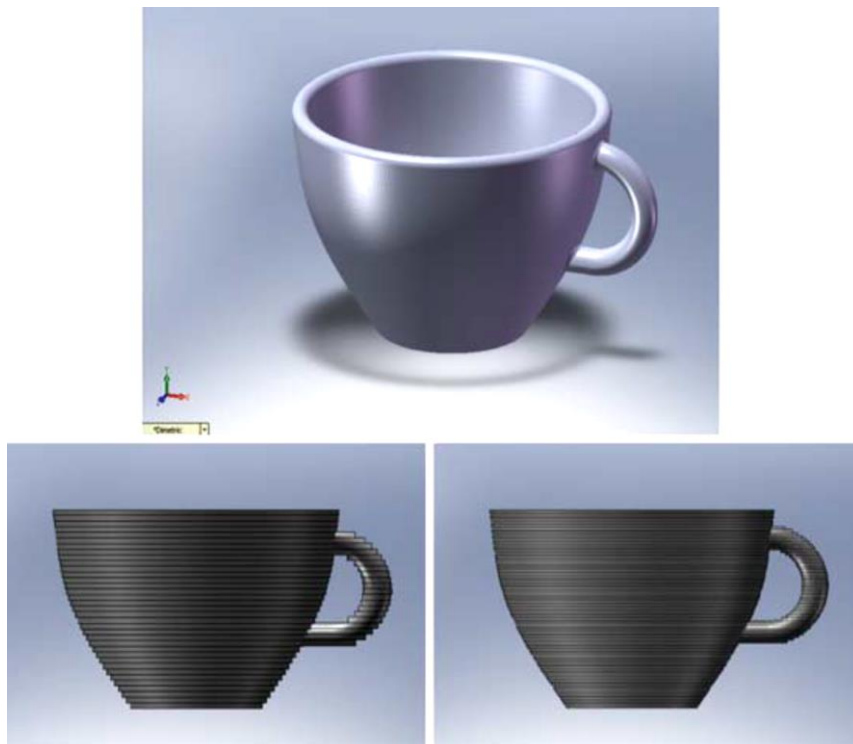
Figura 2.6. Modello CAD dell'oggetto in questione (sopra), confrontato con i risultati ottenibili dalla messa in forma tramite AM con layers di maggiore e minore spessore (rispettivamente a sinistra ed a destra) (Gibson et al., 2010).
