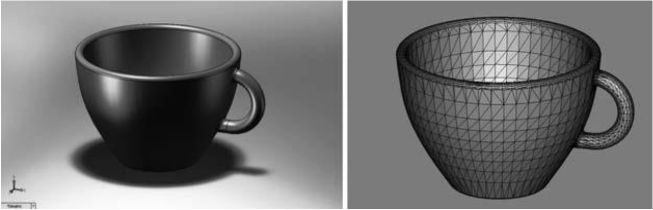
Figura 2.5. Modello CAD dell'oggetto in questione (a sinistra), confrontato con il progetto stesso convertito in formato STL (a destra) (Gibson et al., 2010).
