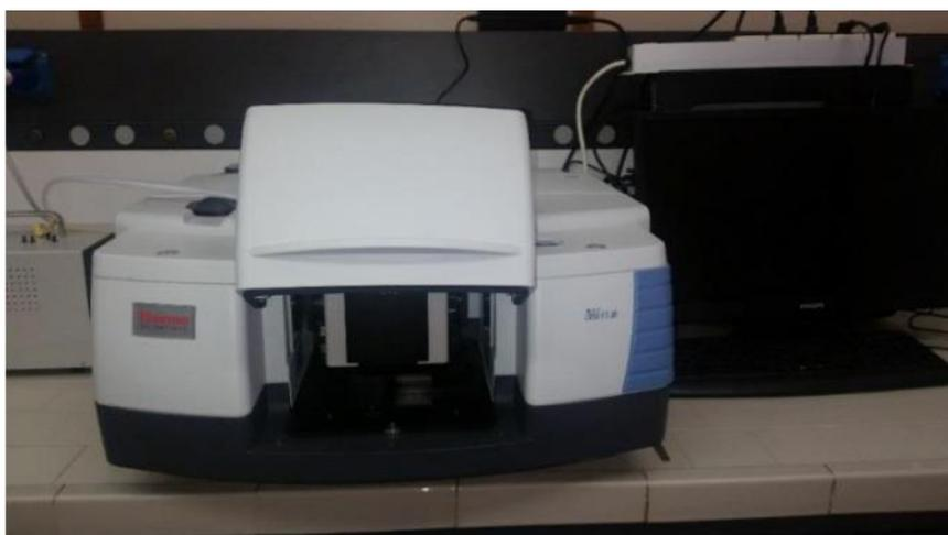
**Figura 26:** Spettrometro Thermo FTIR Nicolet iS50.
