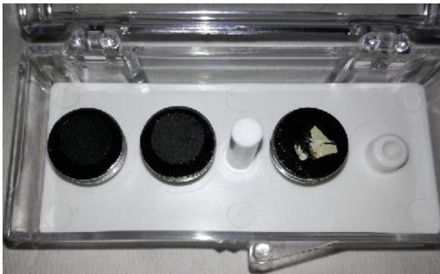
**Figura 19:** Campioni utilizzati per l'analisi SEM. Campione 2 In in polvere (sinistra); campione 2 Out in polvere (centro); campione di supporto del monolita (destra).
