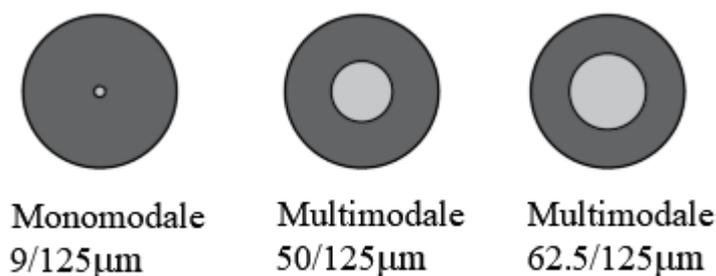
Figura 1.6 Dimensioni tipiche fibre ottiche
