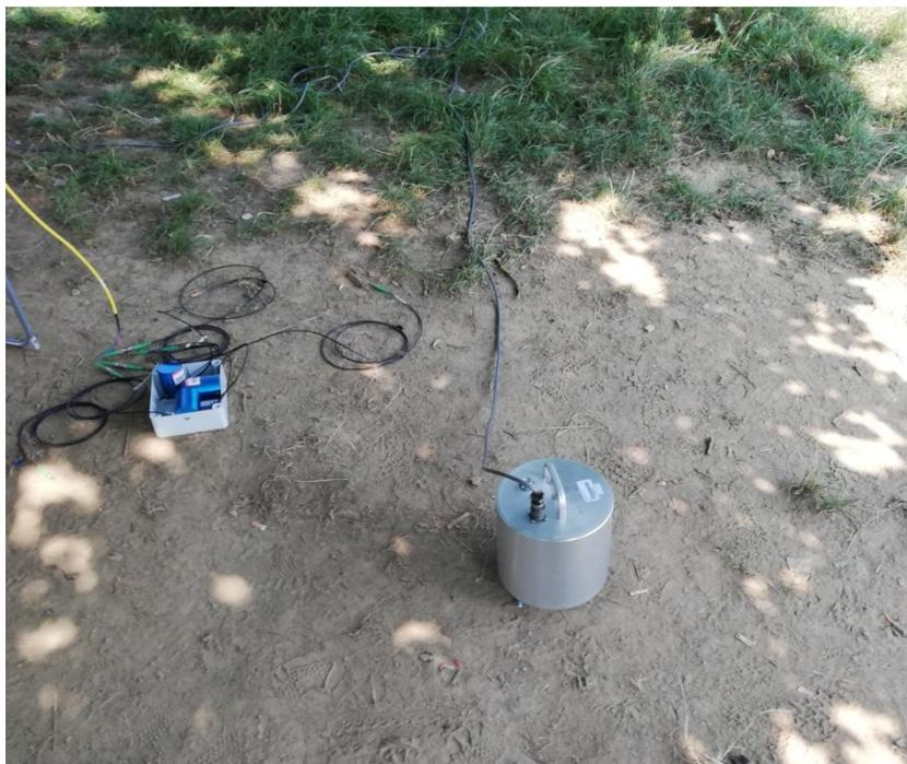
*Figura 5.4 Sismometro e accelerometro triassiale posizionati in corrispondenza del punto di misura*
