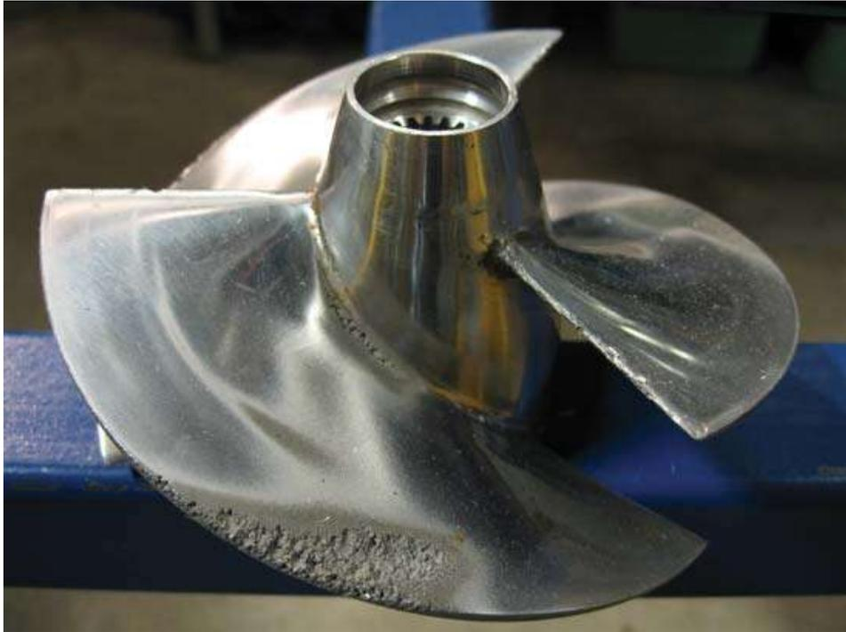
Figura 2.1.4: Danni causati dalla cavitazione sull'elica di una nave. Immagine tratta da [11].
