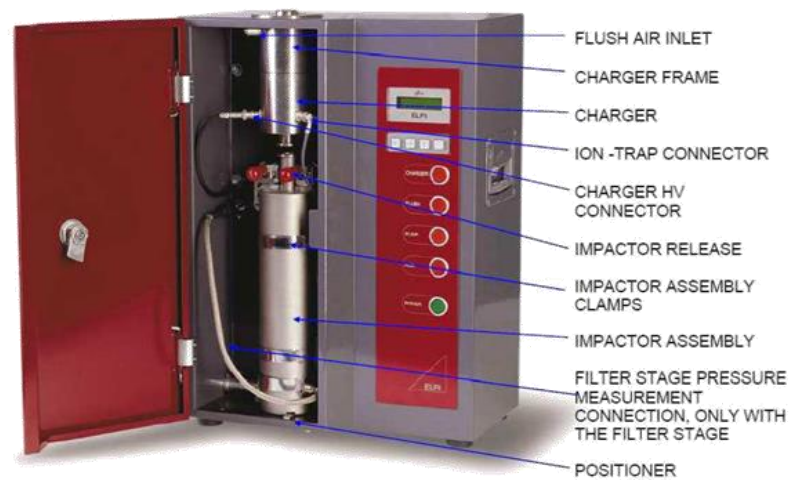
Figura 9: Schema dei componenti dell'ELPI (Manual e ELPI, Dekati)
