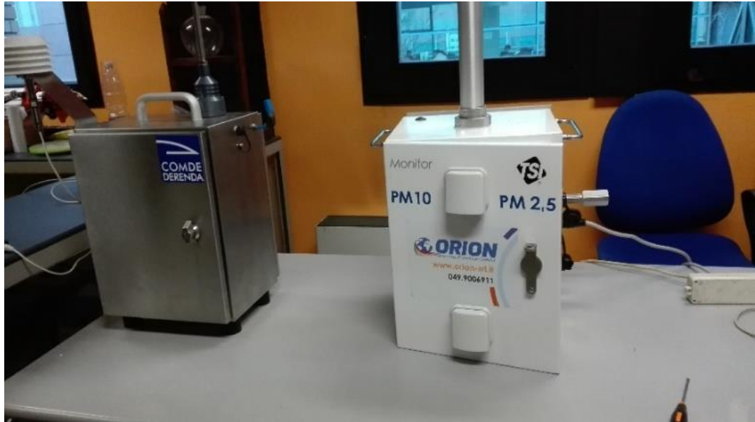
Figura 16: TSI indoor presso il Dipartimento di Ingegneria per l'Ambiente e il Territorio del Politecnico di Torino
