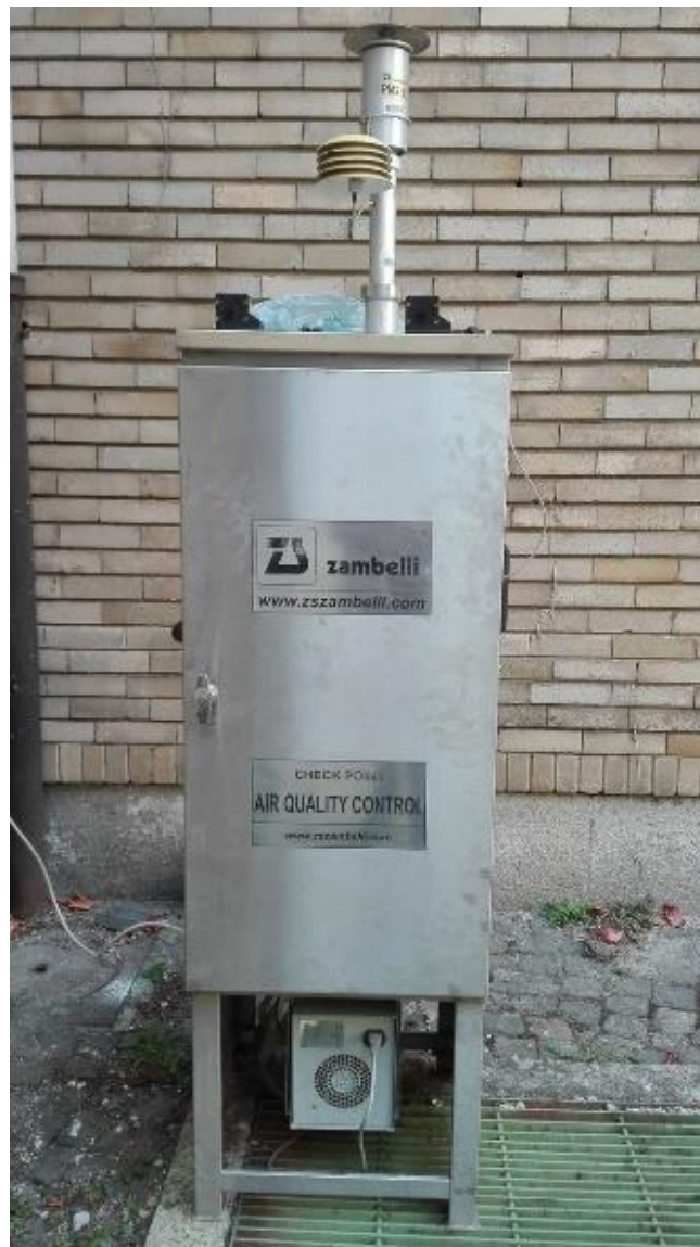
Figura 17: Gravimetrico outdoor presso il Dipartimento di Ingegneria per l'Ambiente e il Territorio del Politecnico di Torino
