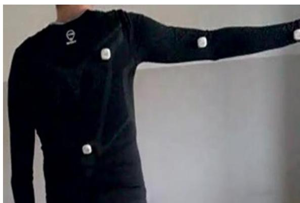
*Figura 2.9: esempio di applicazione di sensori alla maglietta indossata in fase sperimentale, sono posizionati 4 sensori in punti identificativi per i rilevamenti dei movimenti dell'arto destro (vista posteriore)*
