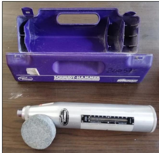
*Figura 39. Strumentazione per la prova sclerometrica*
