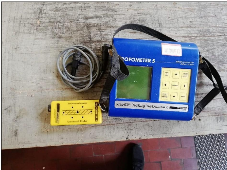
*Figura 38. Strumentazione utilizzata per la prova pacometrica*
