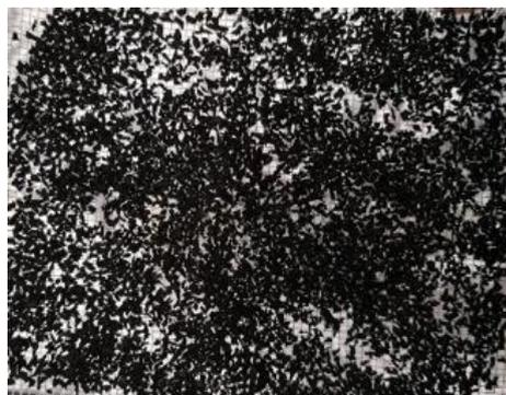
Figura 35 - Disposizione granuli di gomma da PFU
