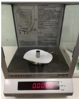
Figura 42 - Cilindretto di volume noto per calcolo peso specifico
