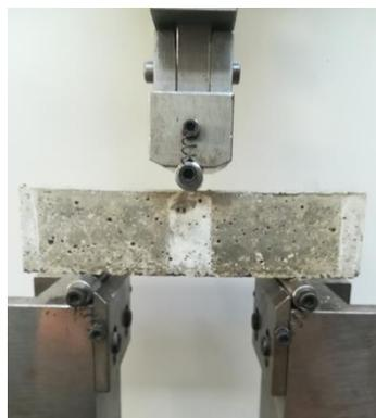
Figura 45 - Strumentazione prova di flessione
