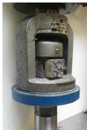
Figura 51 - Esempio rottura a compressione provino serie P
