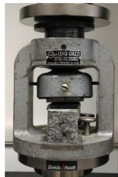
Figura 49 - Supporto per prova di compressione
