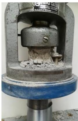
Figura 50 – Esempio rottura a compressione provini serie M
