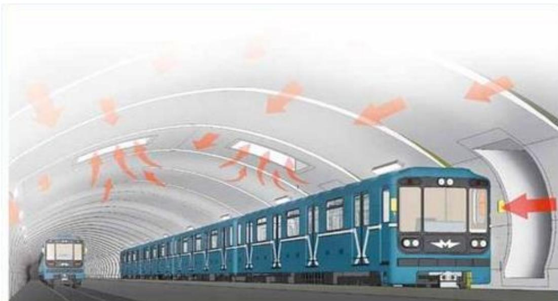
Figura 34: Sistema di ventilazione in una linea metropolitana [18]
