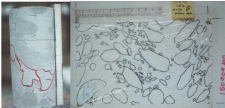
**Figura 2.9: Esempio di provino artificiale creato in laboratorio sul quale è tracciato il percorso di rottura e la rappresentazione della superficie laterale sulla pellicola (Lindquist, 1994) (Fotografie fornite da Medley)**
