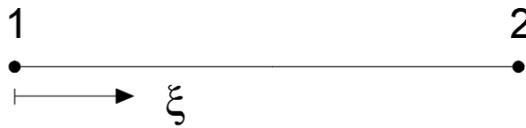
**Figura 5.3** - Elemento di riferimento per la formulazione di ordine 0 EB
