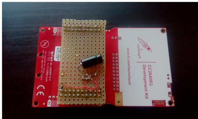
**Figura 5.31:** Oscillatore collegato al microprocessore CC2640.
