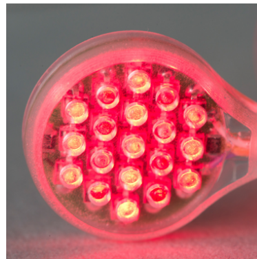
Figura 3.4: Dispositivo di stimolazione Inomed [17].
