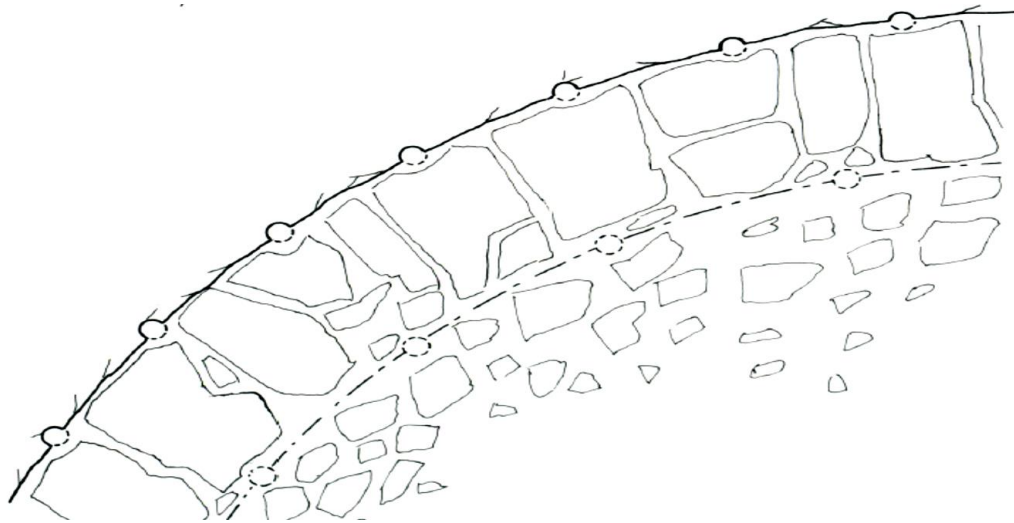
Figura 5 - Esempio di pezzatura più grossolana proveniente dalle mine di contorno rispetto a quella proveniente dalle mine di produzione (Berta 1985)
