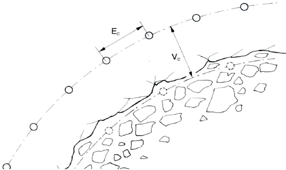
Figura 4 - Formazione di una superficie libera distante V_c dalle mine di contorno a seguito dell'esplosione delle mine di produzione (Berta 1985)
