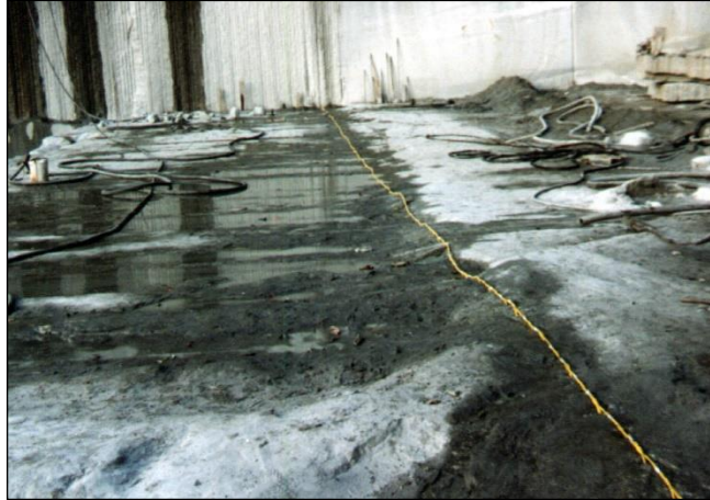
Figura 14 - Caricamento con miccia detonante dei fori di Splitting in una cava di granito (Vari 02/2002)
