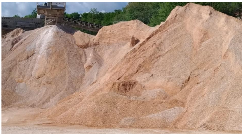
Figura 43 Stabilizzato utilizzato come borraggio [0-18mm]
