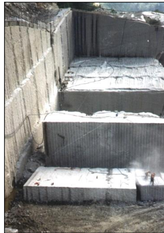
Figura 15 - Cava di pietra dura coltivata con il metodo dello Splitting dinamico (Mancini-Cardu-Lover (Vari 02/2002)
