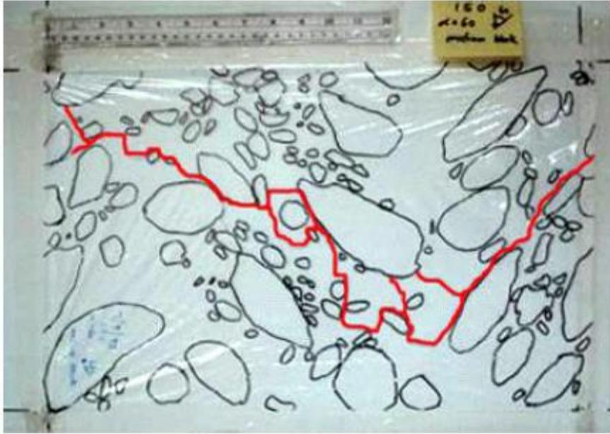
Figura 1.20. Proiezione piana della superficie laterale di un provino con inclinazione dei blocchi a  $60^\circ$  soggetto a prova triassiale; in rosso, la traccia della superficie di rottura (Lindquist, 1994).
