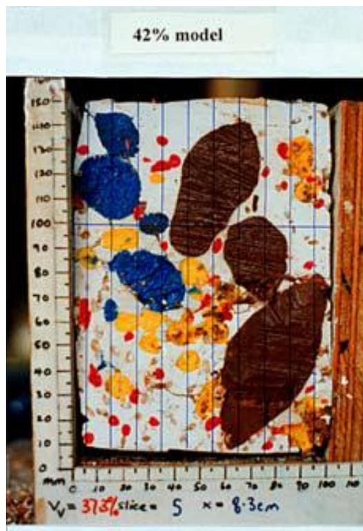
*Figura 1.12. Porzione di campione con percentuale volumetrica dei blocchi pari al 42%, su cui sono tracciati 10 segmenti che simulano i fori di sondaggio in sito (Medley, 1994).*
