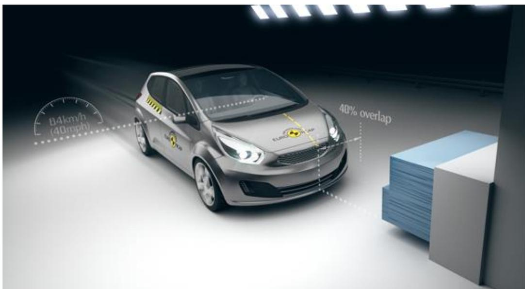
Figura 37.-Barriera deformabile.
