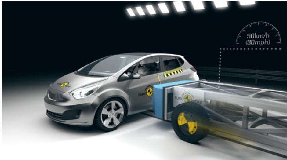
*Figura 39.-Barriera deformabile.*
