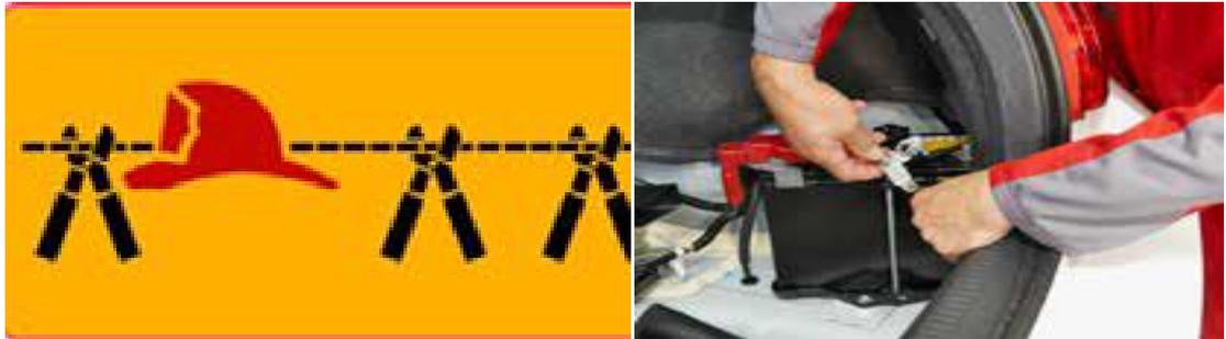
Figura 98.-Etichetta disconnessione e taglio morsetti 12 V
