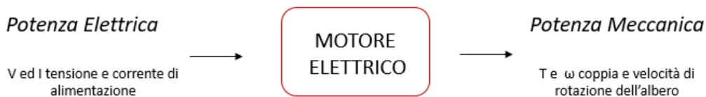
Figura 32.- Motore Elettrico.
