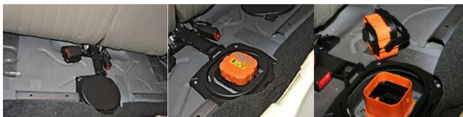
*Figura 89.-Disconnessione Service Disconnect*
