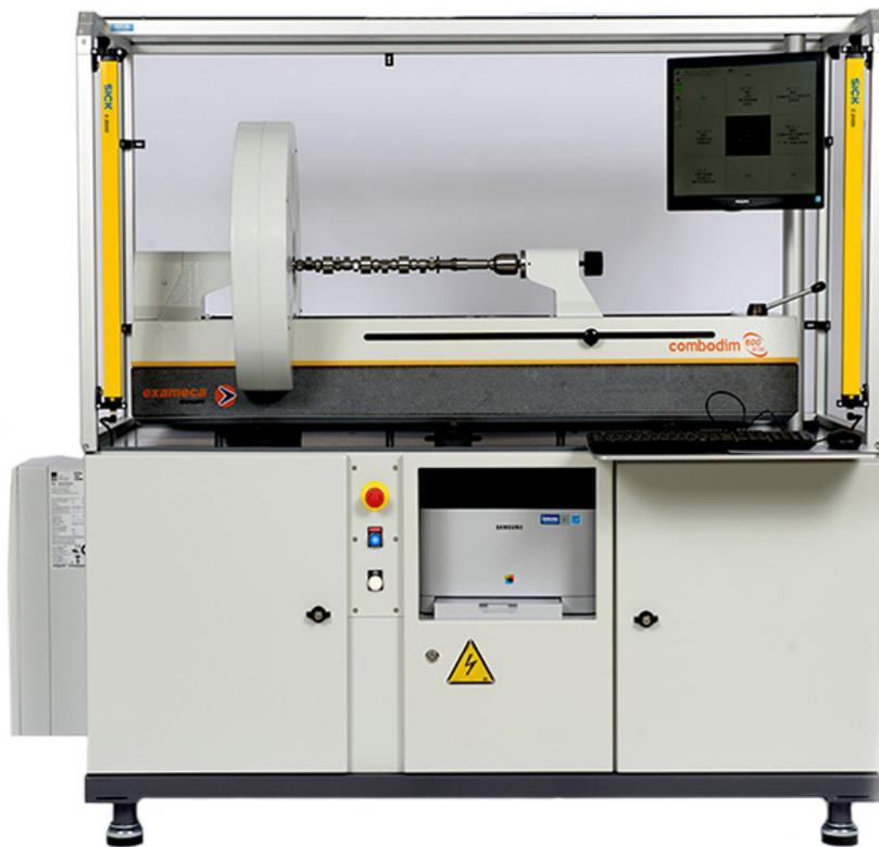
Figura 7.1: Macchina Exameca utilizzata come nuovo sistema di misura
