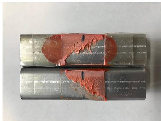
FIGURA 78 - ALLUMINIO OVERLAP 22X15 MM      FIGURA 79 - ALLUMINIO OVERLAP 22X30 MM
