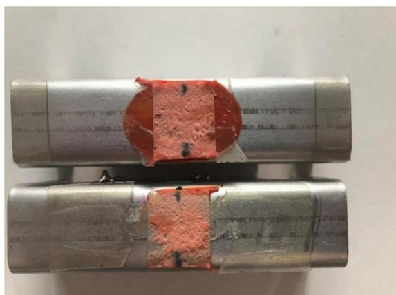
FIGURA 68 - ALLUMINIO OVERLAP 22x15 MM
