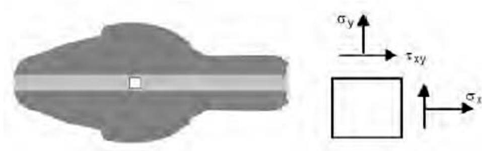
FIGURA 18 - TENSIONI BIDIMENSIONALI IN STRATO ADESIVO (14)
