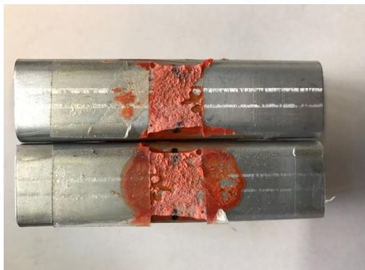
FIGURA 82 - ACCIAIO OVERLAP 22x15 MM
