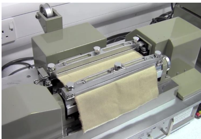
Figura 55- La stessa macchina viene utilizzata sia per la prova di trazione che per quella di taglio, con il provino di tessuto fissato tra due supporti: nella prova di trazione i due supporti si allontanano tra di loro, tendendo le fibre del materiale. Nella prova di taglio, i due supporti scorrono reciprocamente a destra e a sinistra, generando uno sforzo di taglio sul provino (Fonte: Yousef e Stylios)
