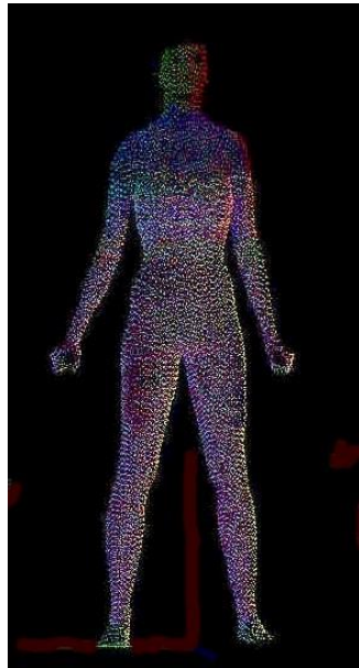
Figura 27- Nuvola di punti generata dalla scansione di un corpo umano (Fonte: College of Textile NC State University)
