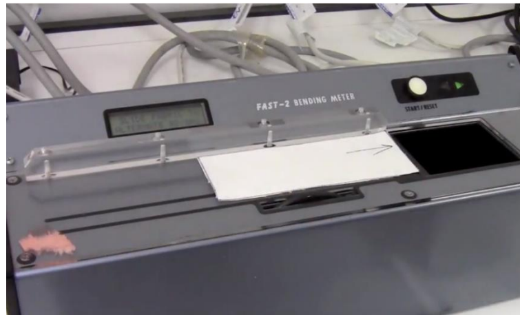
Figura 62- Macchina per misura di flessione FAST-2: il provino di tessuto viene fatto scorrere fino ad una cavità: la misura di flessione viene effettuata calcolando la distanza percorsa necessaria perché il tessuto piegato raggiunga un determinato angolo (Fonte: Yousef e Stylios)
