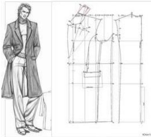
Figura 2- Estrazione dei pattern dallo sketch di un cappotto da uomo (Fonte: "Il modellismo, sartoriale e industriale" di F. Burgo 2018)
