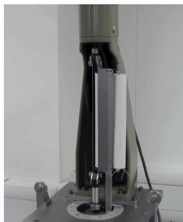
Figura 56- Macchina per la prova di flessione: il provino di tessuto viene bloccato ad un'estremità ad un supporto fisso, all'altra ad un supporto mobile capace di ruotare attorno al supporto fisso. Questa rotazione provoca il piegamento del tessuto. (Fonte: Yousef e Stylios)
