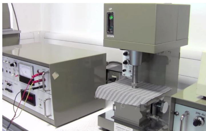
Figura 57- Macchina per la prova di compressione: il tessuto viene posizionato su di un piano forato e in corrispondenza di questo foro viene fatto scendere un pistone che va a comprimere il tessuto (Fonte: Yousef e Stylios)
