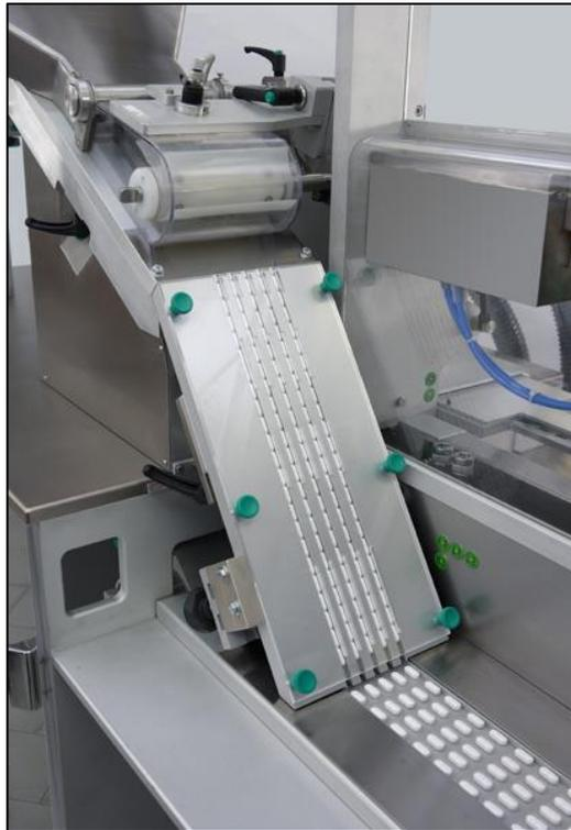
Figura 5: dettaglio della blisteratrice
