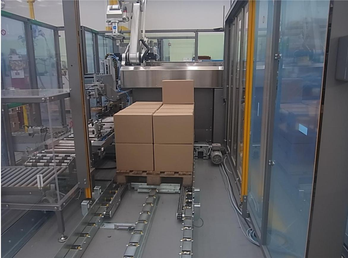
Figura 65: serie di fotocellule che sostituiscono il cancello meccanico
