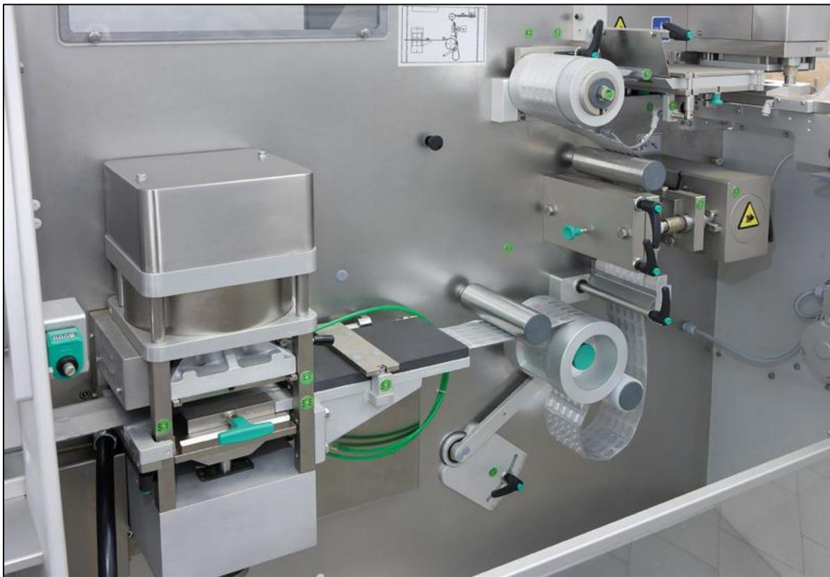
Figura 6: dettaglio della blisteratrice
