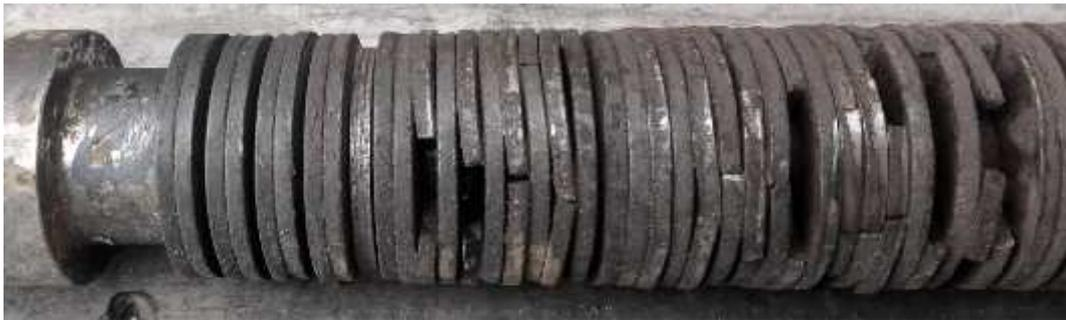
*Figura 5.21 Molla della drawbar danneggiata e sostituita*
