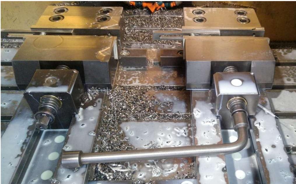
Figura 22: Fissaggio pezzo in morsa
