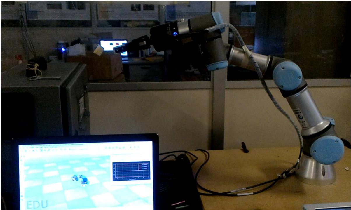
*Figura 94 Prova eseguita in laboratorio con ostacolo liberamente movimentabile in V-REP*
