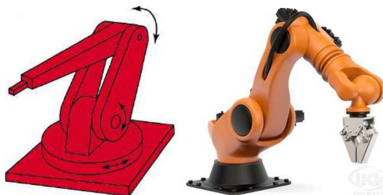
Figura 6 Robot con struttura antropomorfa
