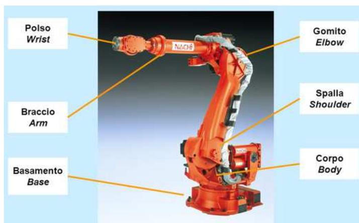
Figura 1 Nomenclatura struttura meccanica robot
