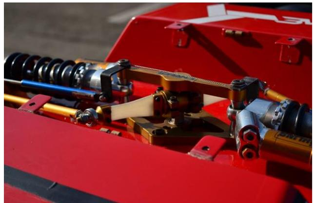
Figura 22: Barre antirollio della vettura SC XV, CAD a sinistra e prototipo a destra
