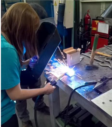
**Figura 114: Operazione di saldatura di push rod e tie rod**
