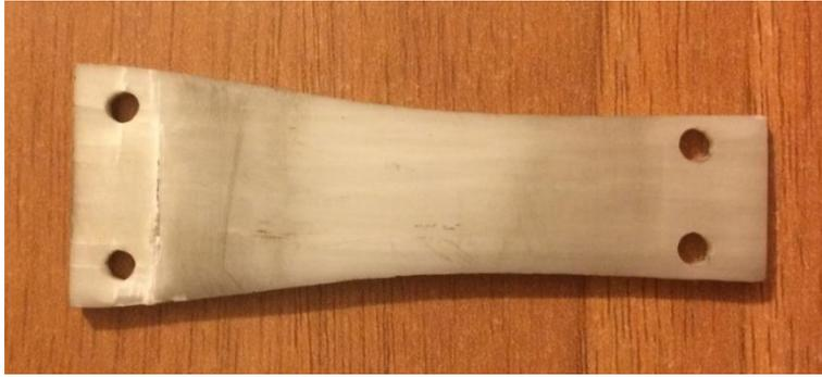
Figura 175: Provino portato a rottura
