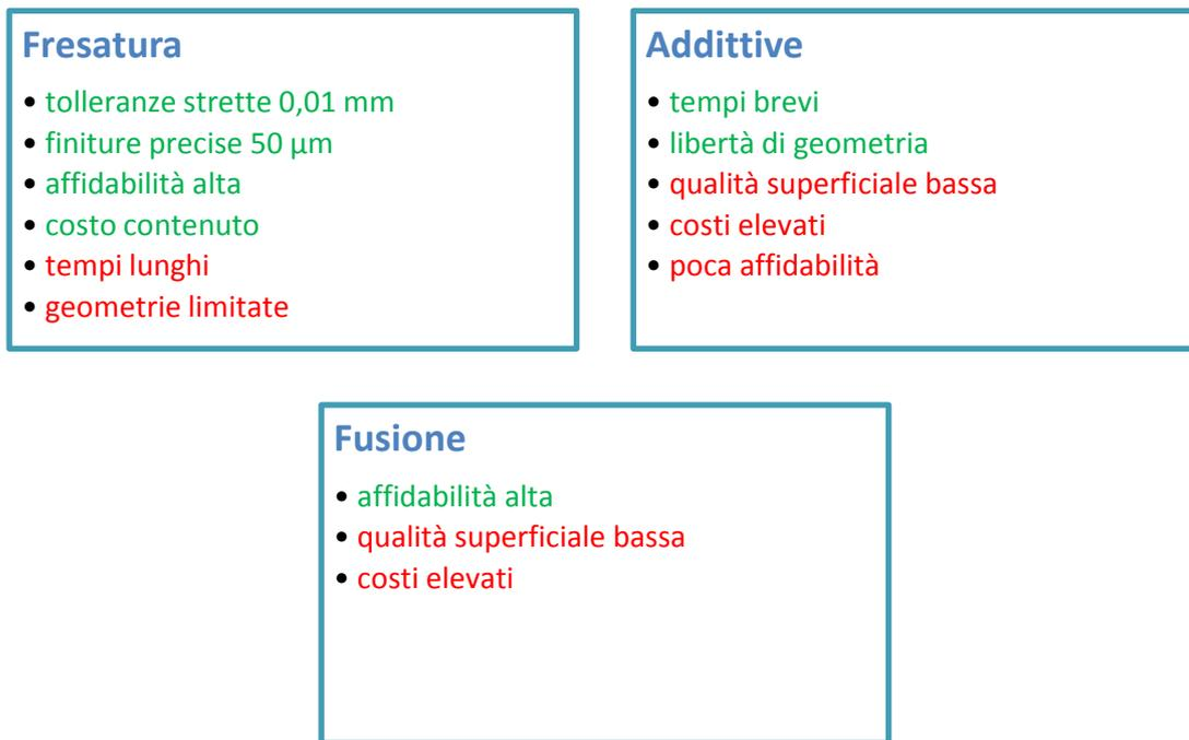
Figura 49: Punti forti e punti deboli delle tecniche produttive considerate per la realizzazione del montante
