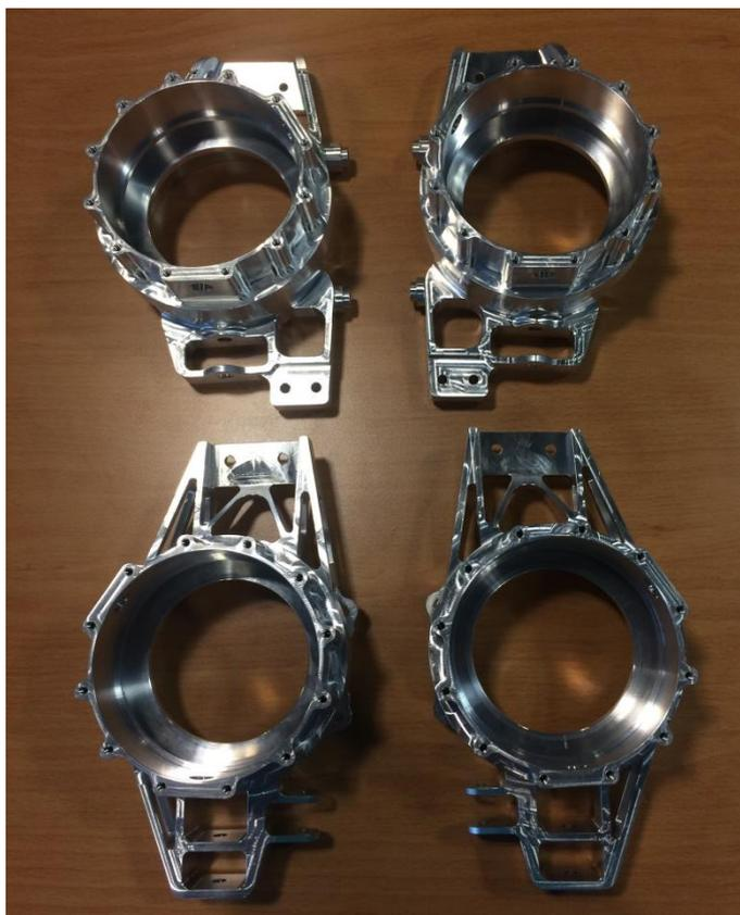
Figura 86: Montanti della vettura SC 17 dopo la fresatura
