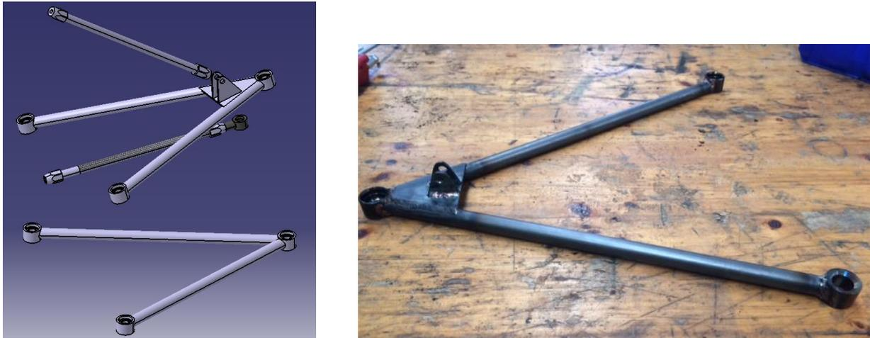
Figura 27: Bracci sospensione della vettura SC XV, CAD a sinistra e prototipo a destra
