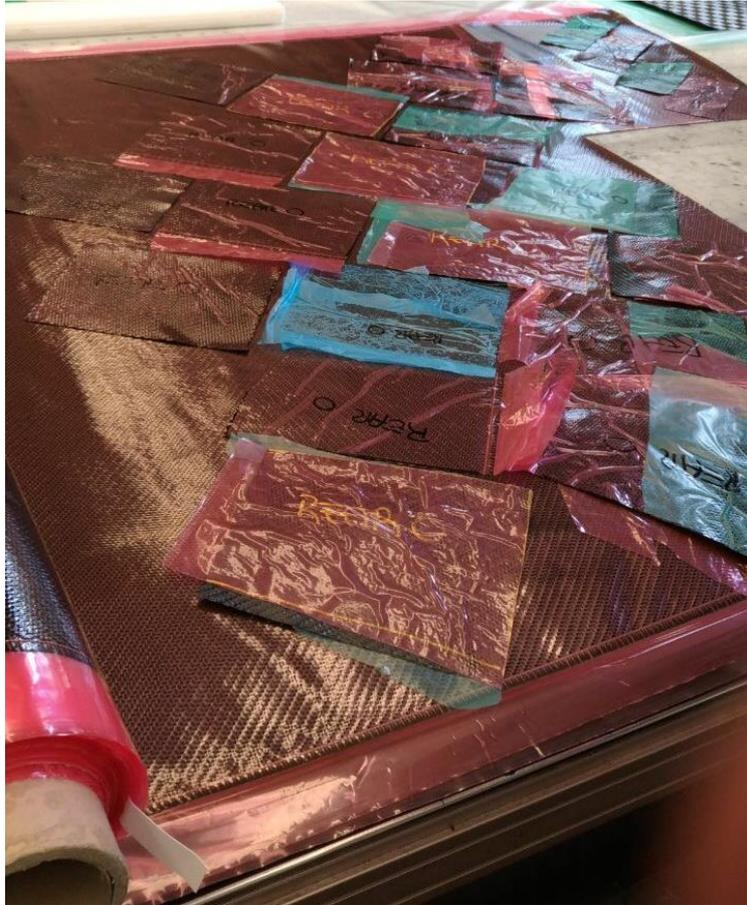
**Figura 135: Operazione di taglio delle pelli per la laminazione dei rocker**
