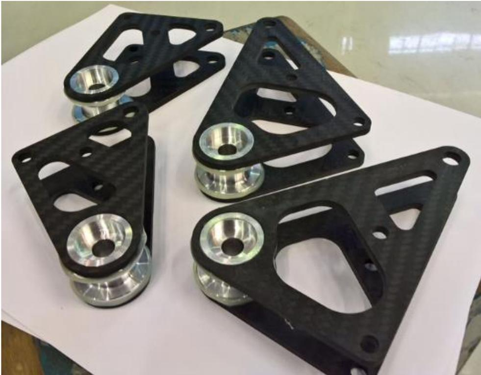
Figura 118: Rocker della vettura SC 17
