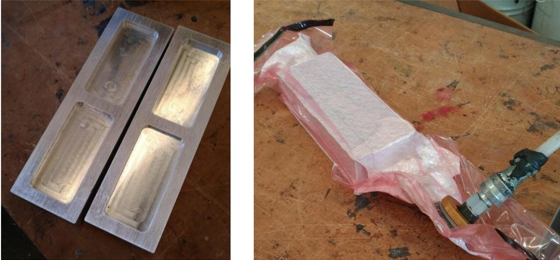
Figura 163: Stampi prima e durante il processo di laminazione delle lastre di fibra di vetro
