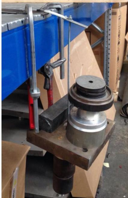
Figura 140: Prova sperimentale di flessione su un provino in fibra di vetro
