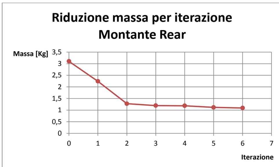
Figura 76: Riduzione della massa per ogni iterazione del montante rear
