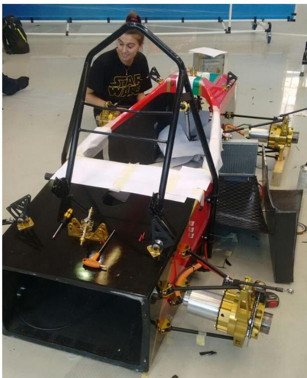
Figura 165: Fase di montaggio delle Sospensioni
