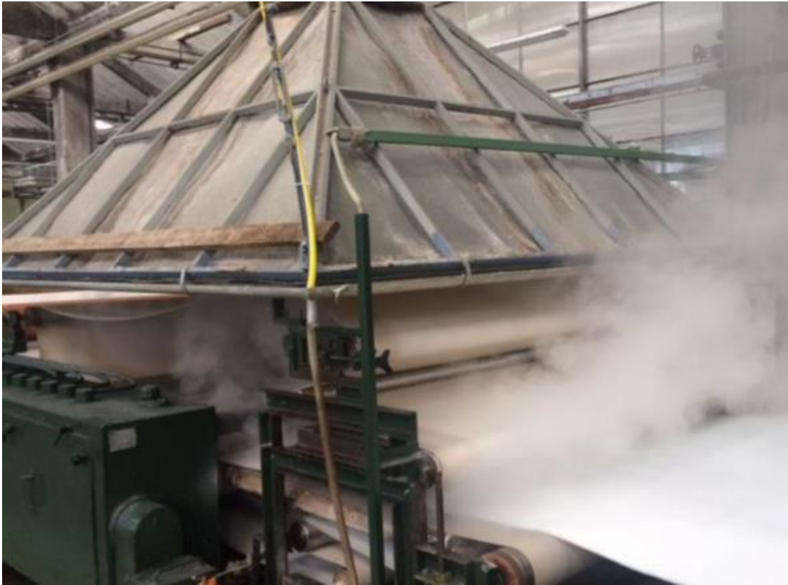
Figura 8: fase di feltratura.
