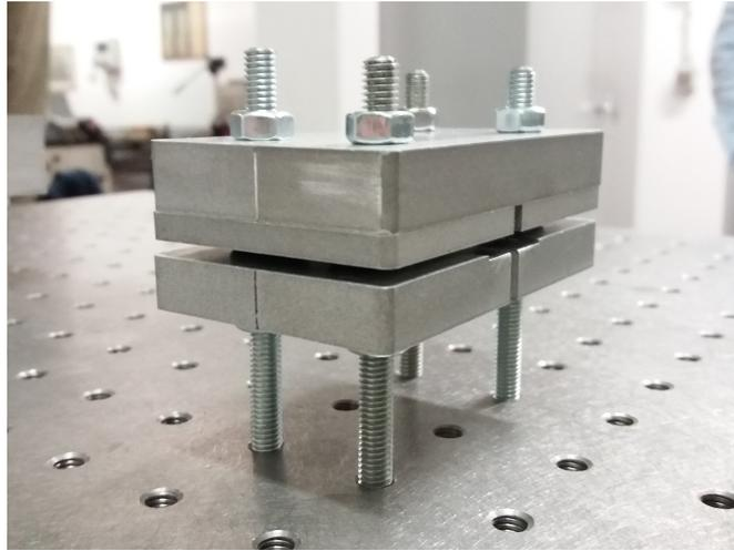
Figura 4.16. Complessivo del sistema per test termico
