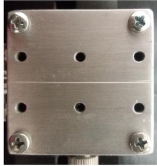
Figura 4.6. Base inferiore con particolare sulla scanalatura a V
