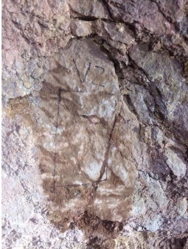
*Figura 3.30 - Area preparata per la prova con sclerometro*
