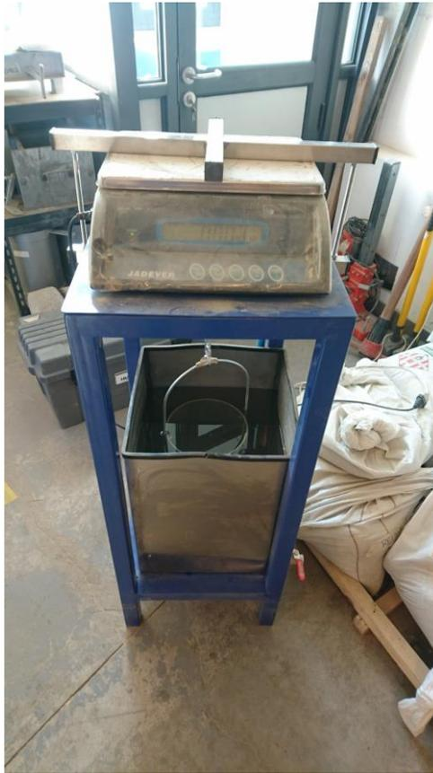
*Figura 3.9 - Bilancia Idrostatica*
