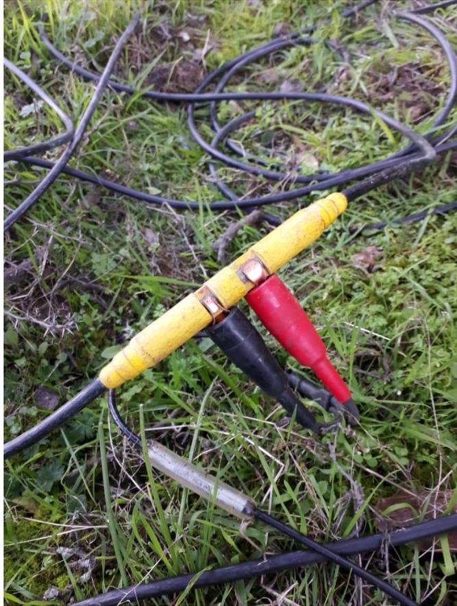
*Figura 3.46 - Collegamento geofono-cavo sismico*
