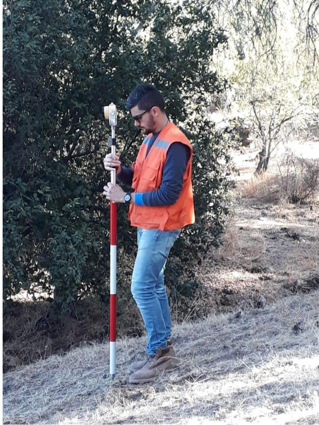
*Figura 2.5 - Dettaglio uso prisma per stazione totale*
