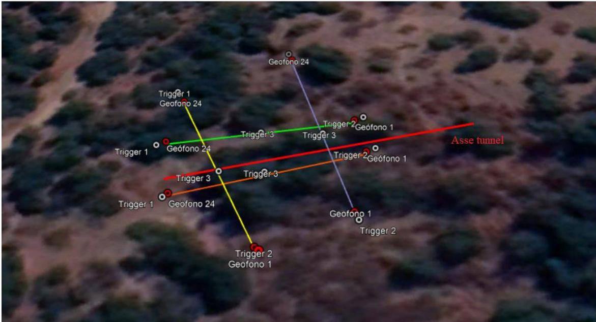
Figura 3.42 - Disposizione stendimenti e asse del tunnel
