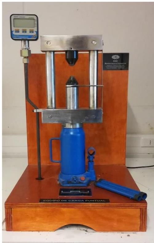
Figura 3.17 – Macchina per la prova di carico puntuale.
