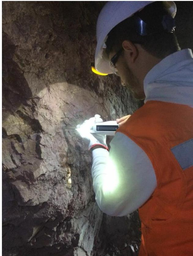
*Figura 3.31 - Esecuzione prova con sclerometro*
