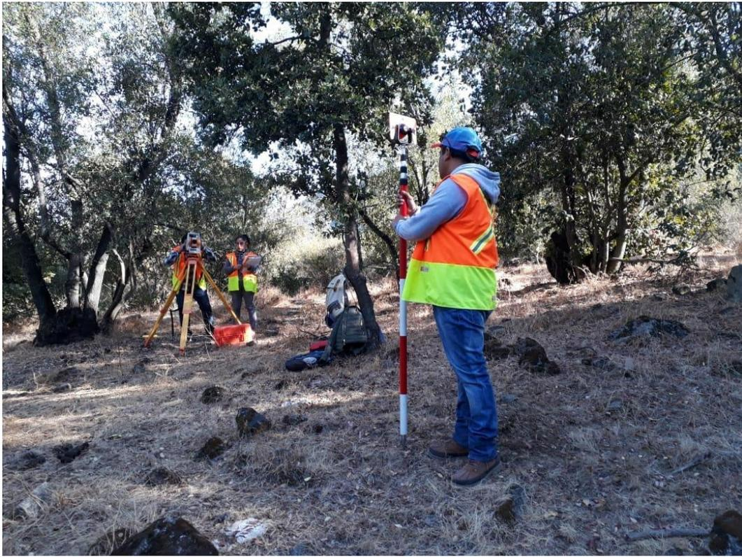
*Figura 2.3 - Dettaglio uso stazione totale e prisma*
