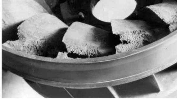
Figura 2.2: Esempio di danneggiamento, causato dalle onde d'urto generate dal collasso di bolle, delle pale di una turbina [13]
