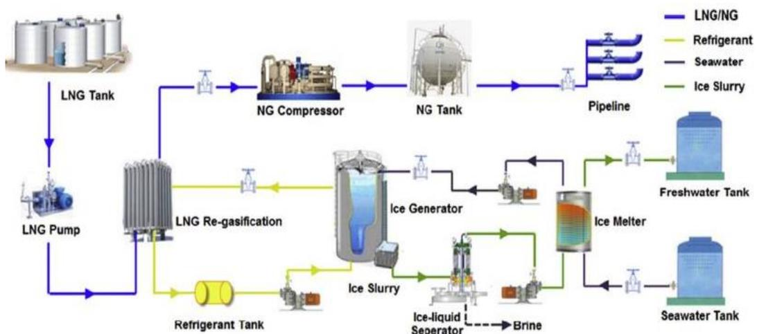
**Figura 5.8** - Seawater Freezing Desalination accoppiato con rigassificazione LNG [35]
