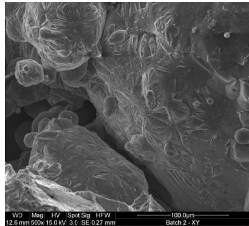
(d) Porosity-induced local brittle fracture - 500x magnification
