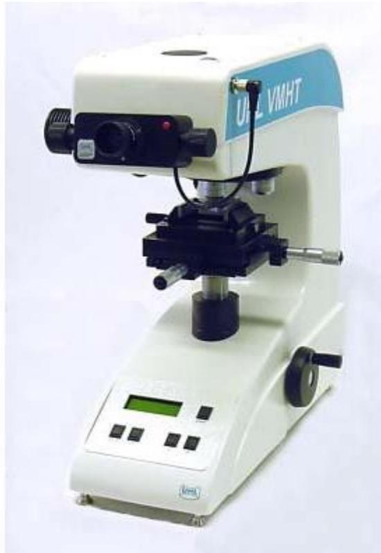
**Figura 3.8:** Indentatore micro-Vicker Leica VMHT.
