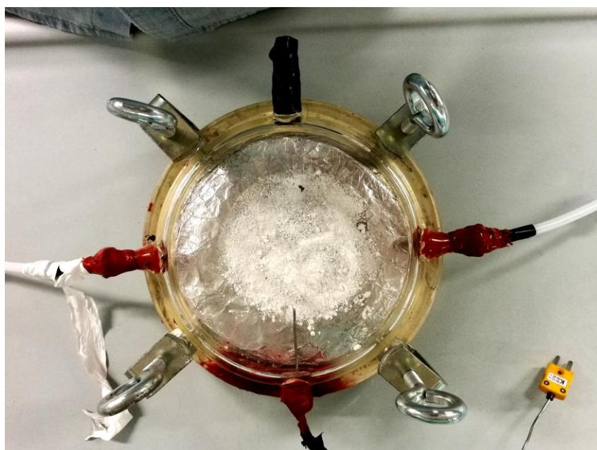
**Figura 4.3:** Reattore in Pyrex, con catalizzatore disposto in un diametro di 10 cm.
