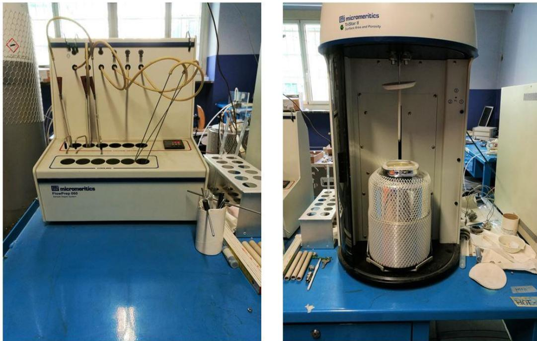
**Figura 3.1:** Strumento utilizzato per il degasaggio (a sinistra), strumento utilizzato per la analisi BET (a destra).
