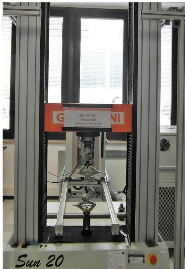
**Figura 2.3-**Macchina di trazione e compressione Galdabini;
