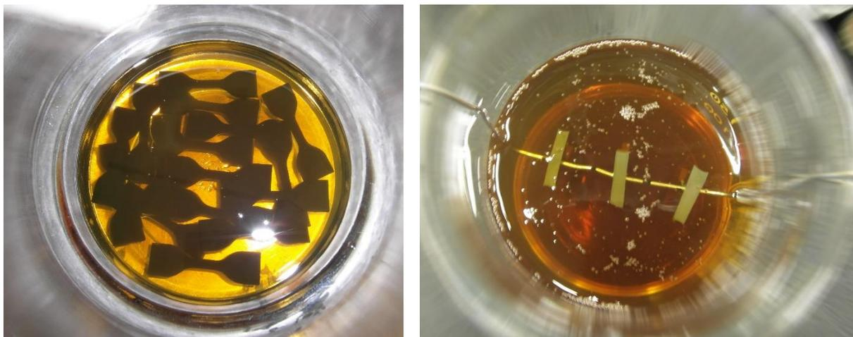
**Figura 2.2**-Immagine a sinistra: campioni invecchiati a temperatura ambiente, immagine a destra: campioni invecchiati a temperatura pari a  $120^{\circ}\text{C}$ ;
