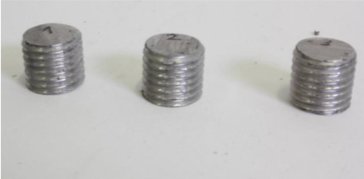
Fig. 2.19: campioni usati per le prove di durezza
