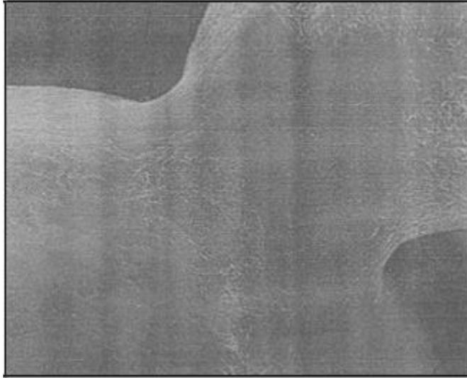
Fig. 1.5: immagine della formazione di un collo tra due particelle
