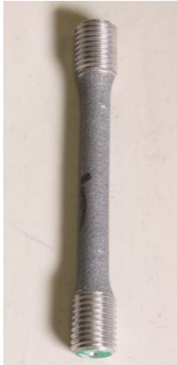
Fig. 2.12: provino di trazione
