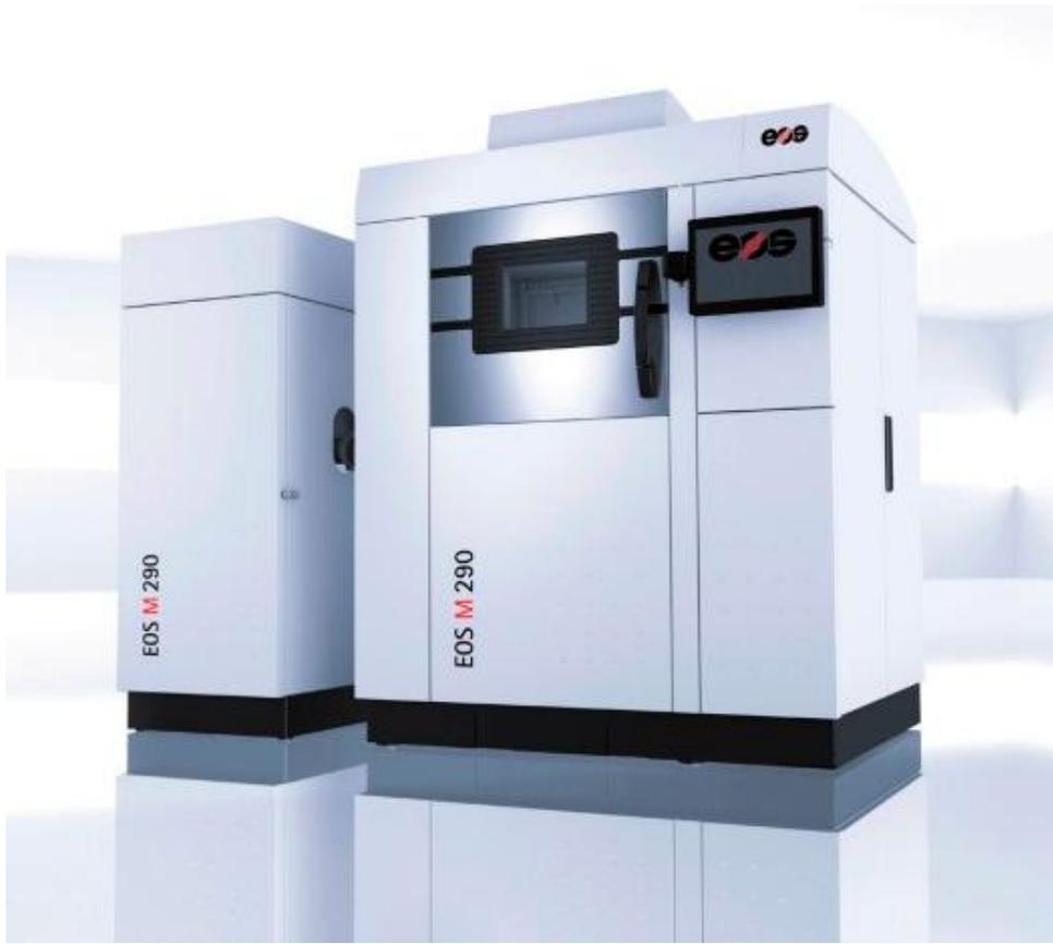
Fig. 2.2: immagine della macchina per SLM utilizzata
