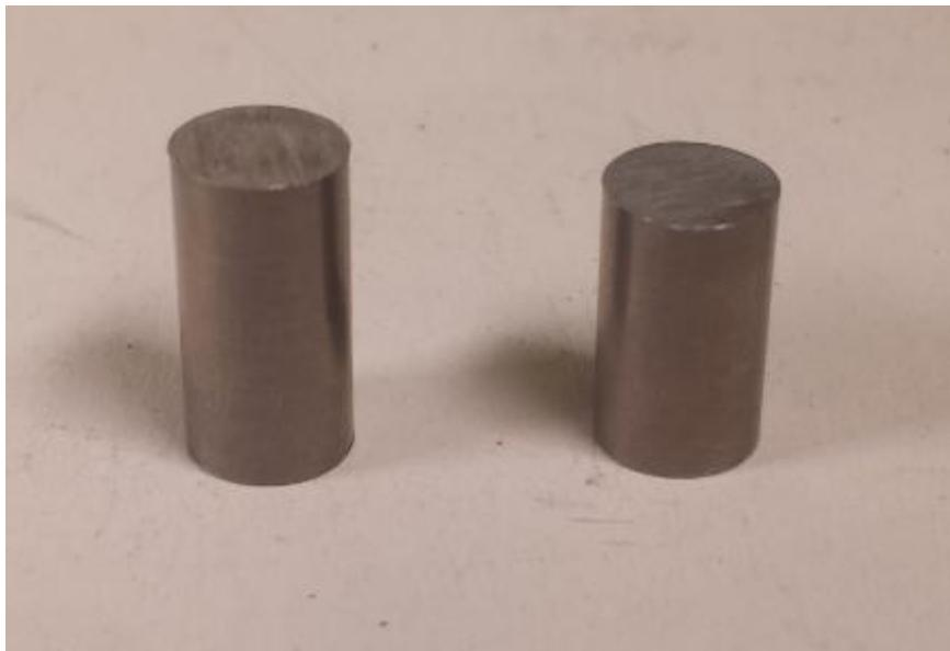
Fig. 2.20: campioni usati per la bilancia di Archimede
