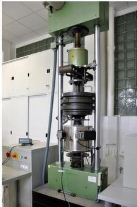
Fig. 2.15: apparecchiatura usata per i test di fatica
