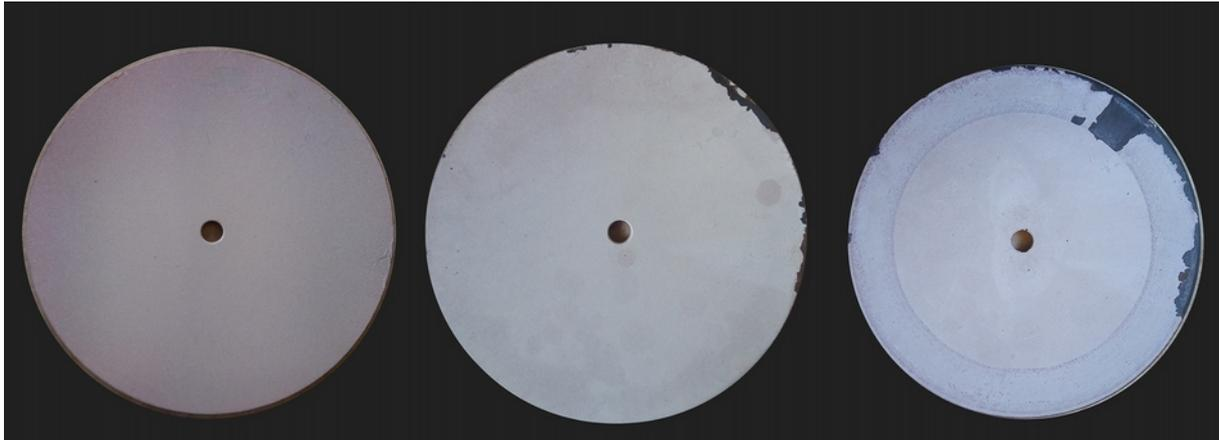
Figura 4.42: A1 immagini macroscopiche del campione prima del test, dopo condizionamento e 500 giri di Taber test.
