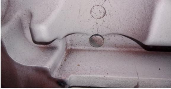
Figura 2.3: Difetto della verniciatura in corrispondenza di un estrattore
