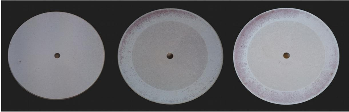
Figura 4.19: A8 immagini macroscopiche del campione prima dei test di usura, dopo 300 giri e dopo 500 giri al Taber test.
