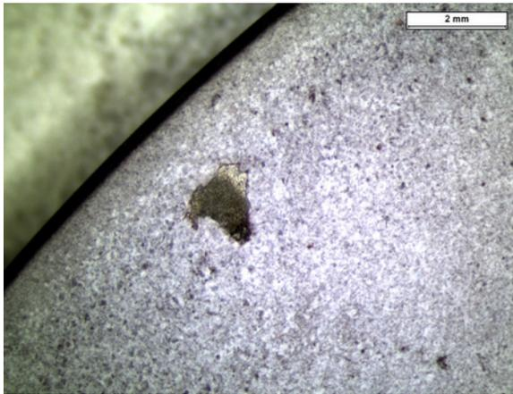
Figura 4.9: A0, 200 giri, dettaglio difetto, Ingrandimento 0,63x.
