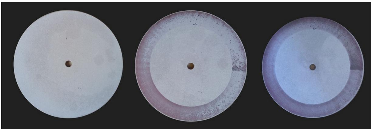
Figura 4.24: A7 immagini macroscopiche del campione dopo il condizionamento e a 300 e 500 giri al Taber test.
