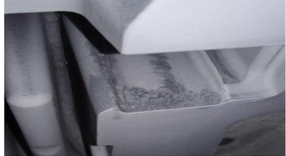
Figura 2.2: Difetto in corrispondenza di un area della figura sensibile al flusso di metallo.
