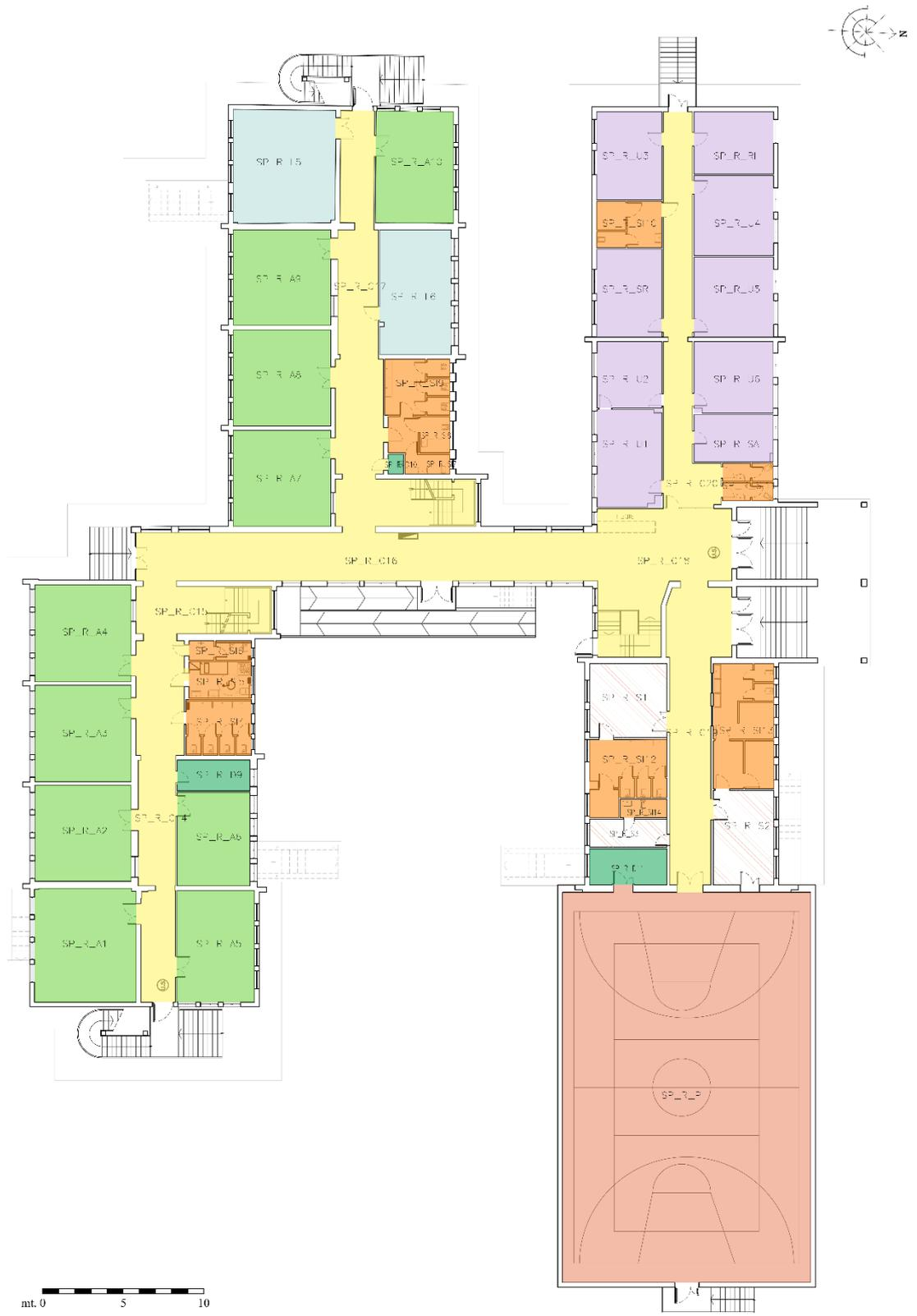
Figura 44 - Stato di progetto, distribuzione funzionale piano rialzato.
