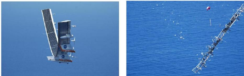
Figura 1.5: Sulla sinistra la configurazione ad alta deformazione del velivolo HELIOS. Sulla destra l'istantanea del cedimento strutturale.
