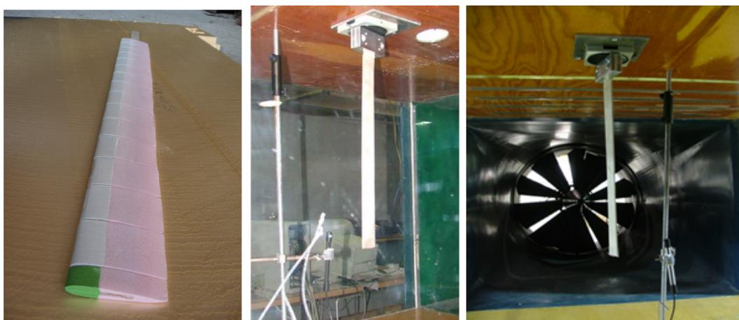
Figura 7.12: Modello scalato di semiala per analisi sperimentale. A sinistra è riportato il modello, a destra lo stesso montato in galleria del vento prima della prova.
