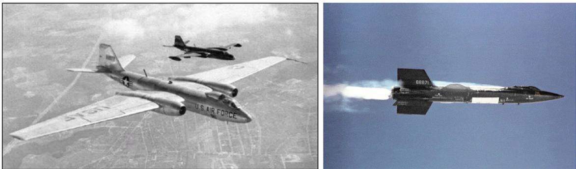
Figura 2.7: A sinistra il velivolo RB-57, configurazione con apertura alare maggiorata rispetto al B-57. A destra il velivolo X-15.
