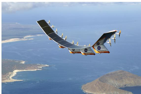
Figura 1.4: Elevata deformazione alare registrata dal velivolo NASA HELIOS durante il volo.
