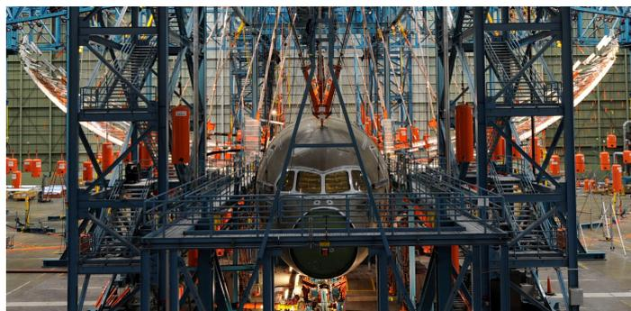
Figura 1.2: Test sperimentale di certificazione a robustezza del velivolo Boeing 787.
