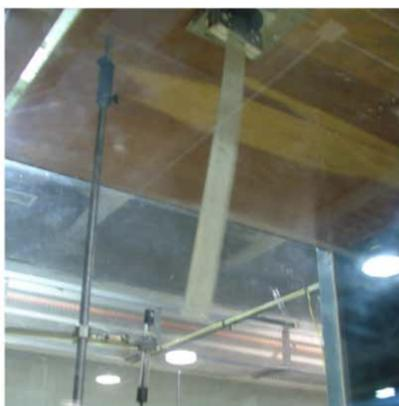
Figura 7.13: Deformata di  $w/b = 2.83$ , ottenuta prima dell'instaurazione del ciclo limite [9].
