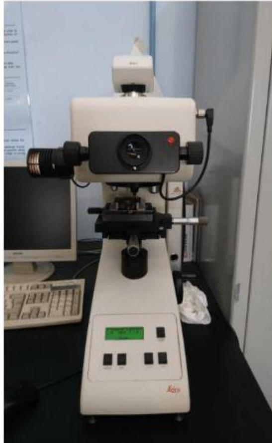
**Figura 2.13:** Microdurometro Leica VMHT
