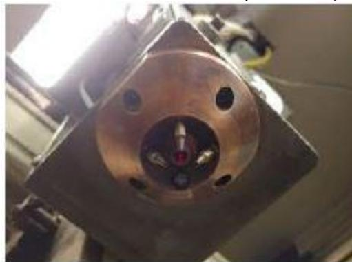
**Figura 2.2b:** Zoom ugelli testa di deposizione
