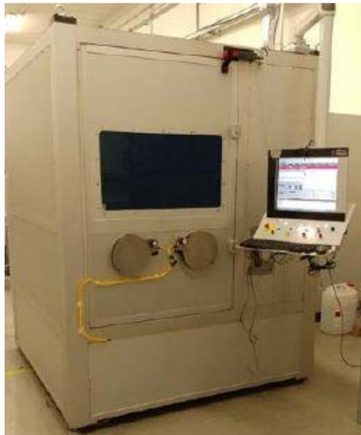
**Figura 2.1:** Prototipo macchina DED prodotto da Prima Industrie S.p.A.
