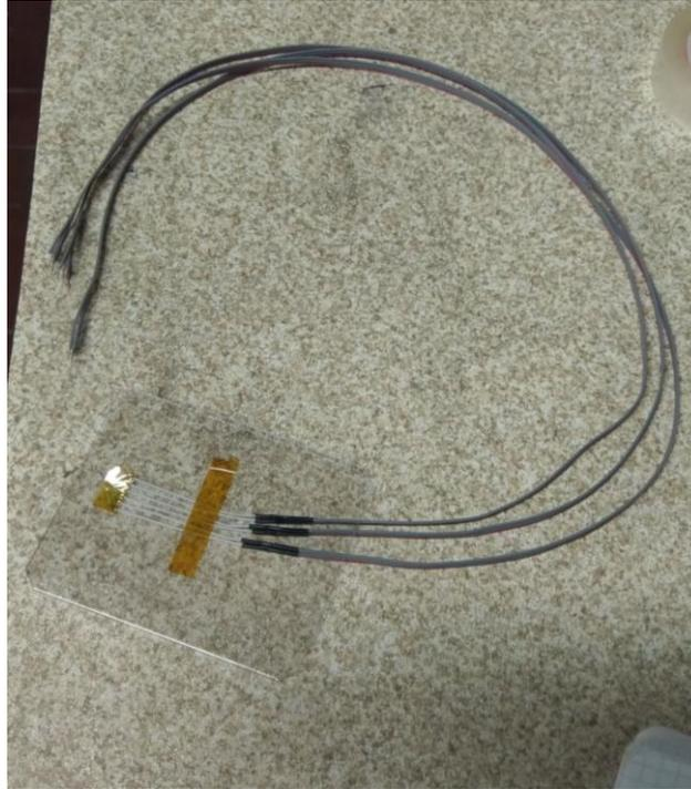
**Figure 2.16:** Rosette estensimetriche tipo B
