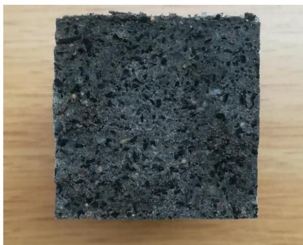
Figura 57 Sezione di frattura dei provini di cemento modificato con GTR
