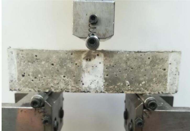
*Figura 26 Provino di cemento posizionato nel macchinario per il test di resistenza a flessione*
