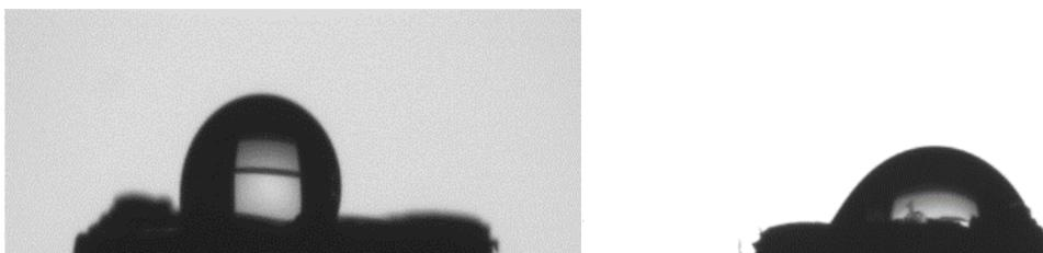
Figura 29 Bagnabilità su granuli di GTR, prima (a sinistra) e dopo (a destra) trattamento al plasma ad aria
