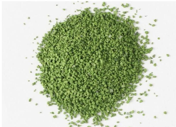
*Figura 12 Gomma 'nobilitata' per campi in erba sintetica (figura tratta da rubber-granules.com)*
