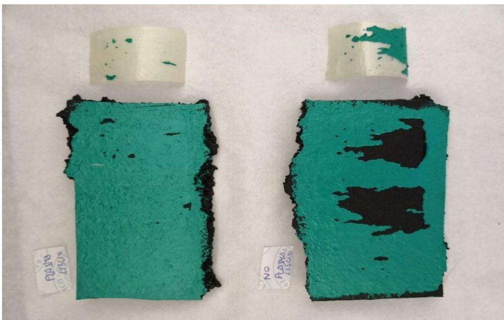
Figura 51 Confronto delle lastre di GTR rivestite con lattice SBR carbossilato lo strappo con nastro adesivo. A destra il campione vergine e a sinistra il campione di GTR trattato plasma.
