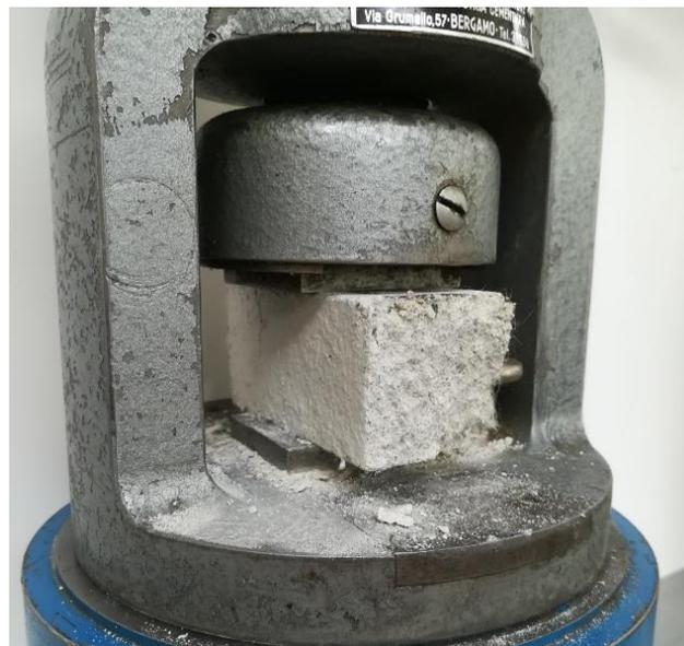
*Figura 27 Provino di cemento all'interno del supporto metallico per la prova di compressione*
