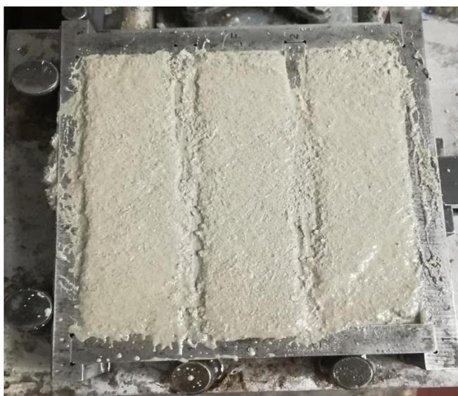
Figura 24 Casseri metallici riempiti con la malta di cemento
