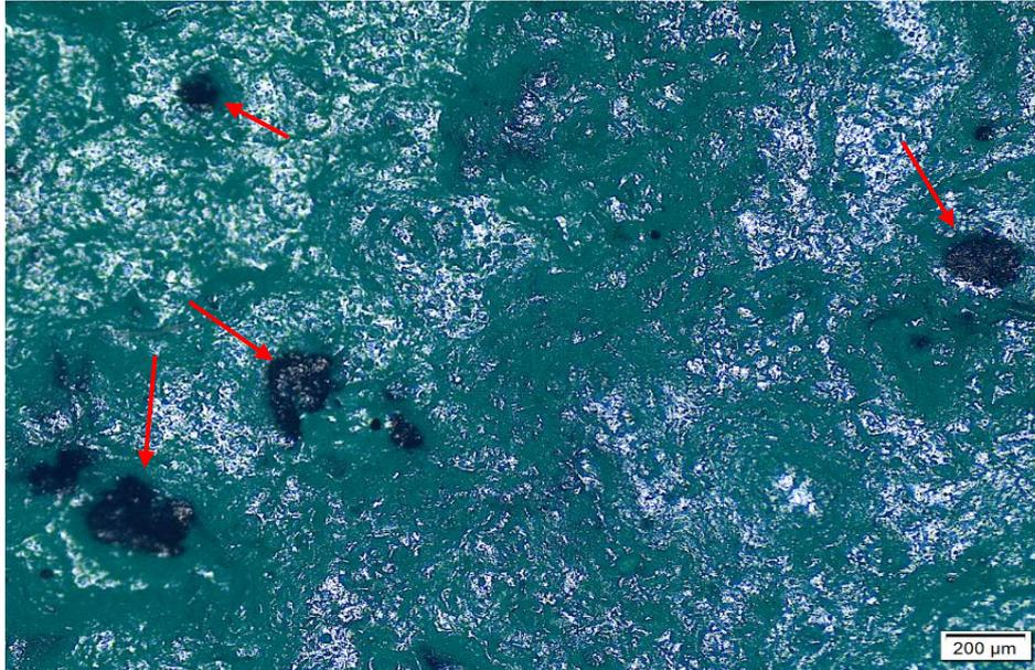
*Figura 48 Superficie della lastra di GTR vergine rivestita con lattice SBR carbossilato*
