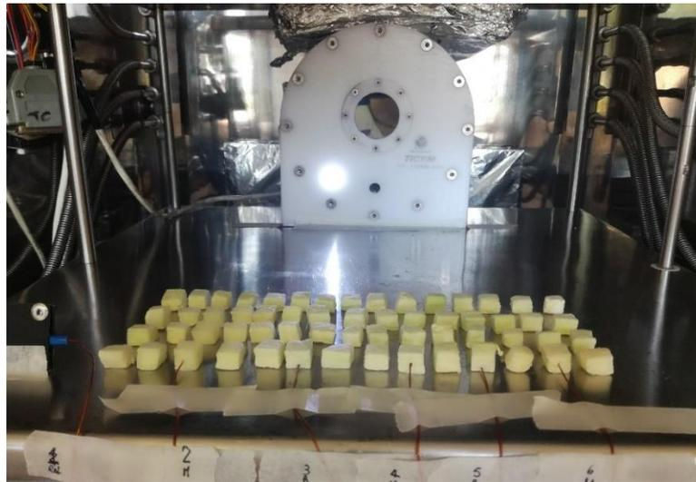
**Figura 2.2:** disposizione dei cubi di melanzane sul ripiano della camera di liofilizzazione. Sono visibili le termocoppie all'interno di alcuni campioni e la termocamera opportunamente posizionata per impedirne lo spostamento a causa delle vibrazioni del macchinario quando in funzione.
