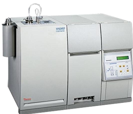
**Figura 2.21** Immagine dell'apparecchio "Thermoquest CE instruments TPDRO 1100", utilizzato per le H<sub>2</sub>-TPR.
