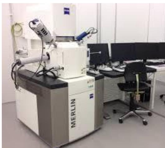
**Figura 2.14** Microscopio Zeiss MERLIN Gemini II utilizzato per l'analisi FESEM
