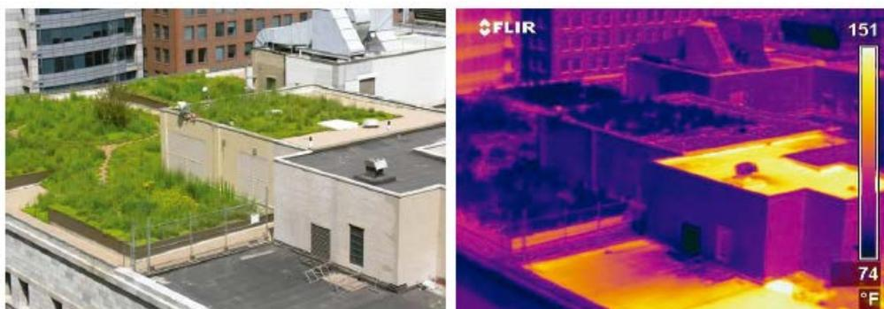
**Fig 4.2:** Differenze di temperature tra coperture vegetale e convenzionale
